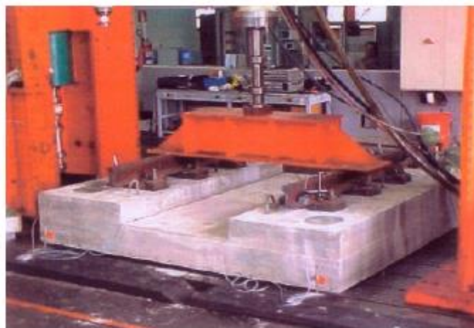
Figura 89: Ensaio de Protótipos com Sistema Massa-Mola composto por Isoamortecedor – Fonte: [METRÔ, 2007]
