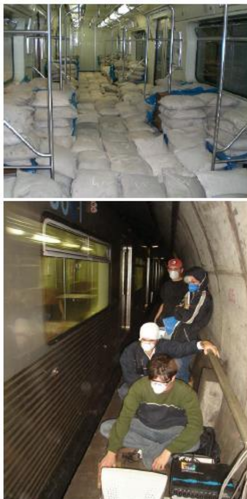
Figura 91: Ensaios de Sistemas de Atenuação em Campo – Fonte: [METRÔ, 2007]
