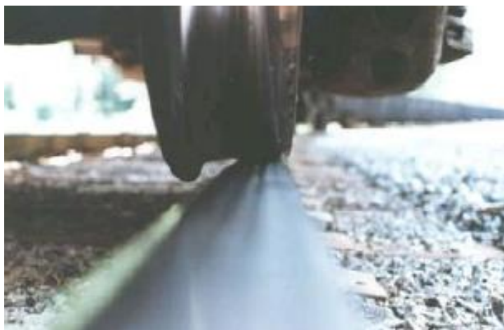
Figura 77: Contato Roda-Trilho – Fonte: [METRÔ, 2007]
