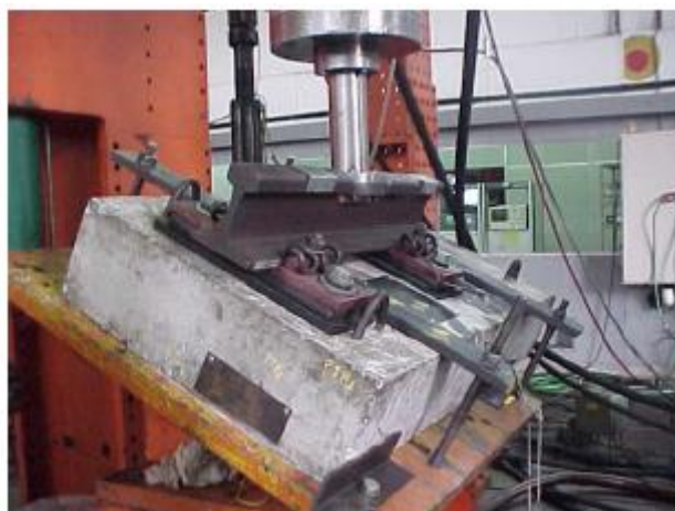
Figura 90: Ensaio em Placas Resilientes para Fixação de Trilhos – Fonte: [METRÔ, 2007]
