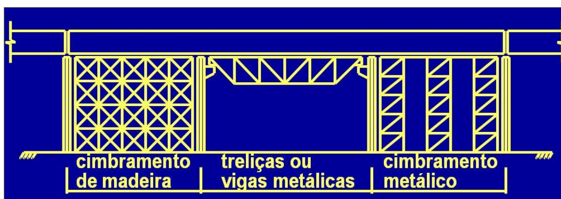
Figura 34: Esquema ilustrativo do método de Cimbramento Fixo
