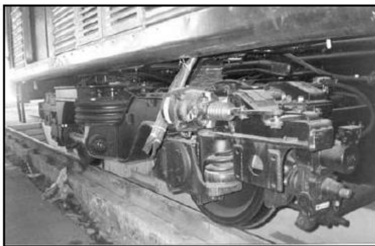
Figura 80: Suspensão de Carros Metroviários – Fonte: [LUZ, 2008]
