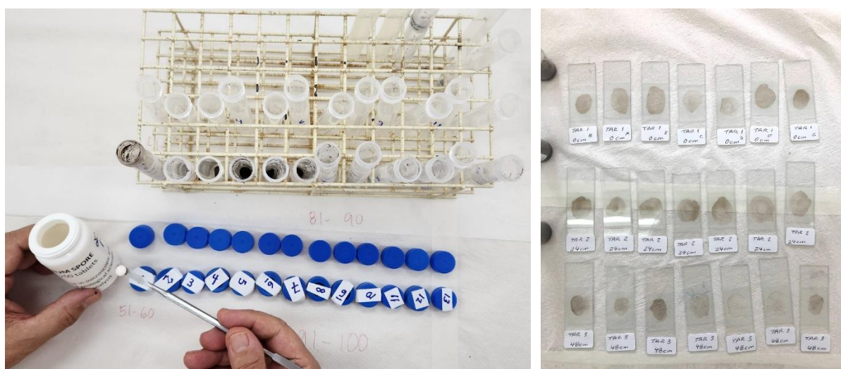
Figura 7 – Registro do processamento químico das amostras e montagem das lâminas de análise. Na foto à esquerda, adição de pastilha de Lycopodium clavatum (Stockmarr, 1971), e à direita, lâminas montadas com o resíduo final do processo químico e prontas para a análise ao microscópio biológico. Foto: Larissa Y. Kiyotani.
