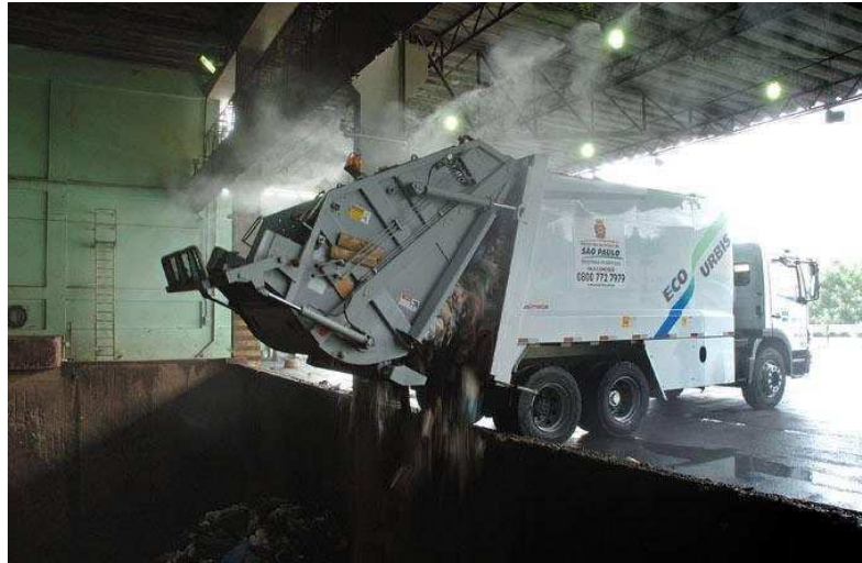
Figura 5: Caminhão coletor descarregando os resíduos sólidos para o fosso na estação de transbordo (Fonte: Ecourbis apud CILIP, 2010)
