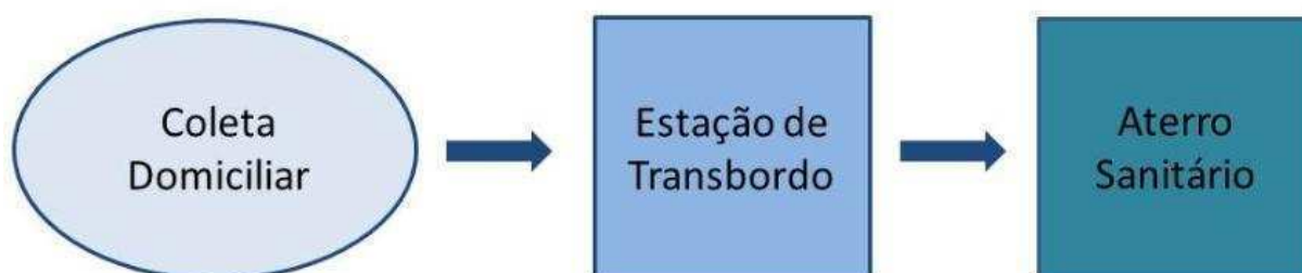
Figura 1: Sistema de coleta, transferência, armazenagem e destinação final do lixo urbano em São Paulo
