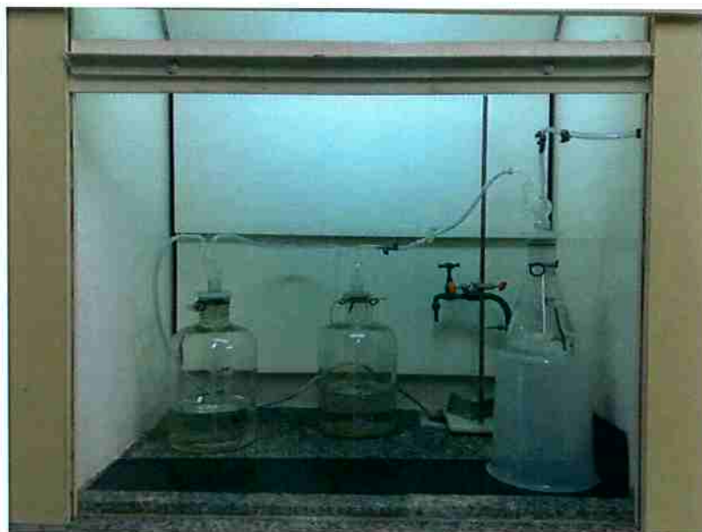
Figura 13 - Sistema de injeção de gás, erlenmeyer contendo corpos-de-prova e vasilhames de NaOH utilizados nos ensaios de perda de massa.
