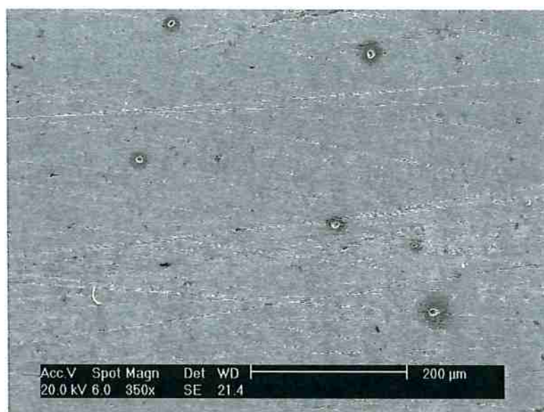
Figura 33 – Outro detalhe da superfície após ensaio de imersão por 1 hora sem H_2S (aumento: 350x).
