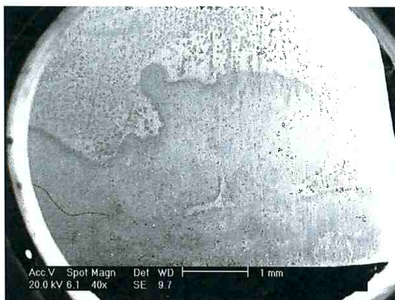
Figura 26 – Exame em MEV, com Aumento de 40x, da Superfície da Amostra Submetida a Ensaio de Perda de Massa por 1 hora em solução 0,5% Ácido Acético, desaerada com gás Nitrogênio e Injeção de H 2 S. Esta superfície apresentou produto de corrosão fino e aderido, na forma de uma mancha preta.
