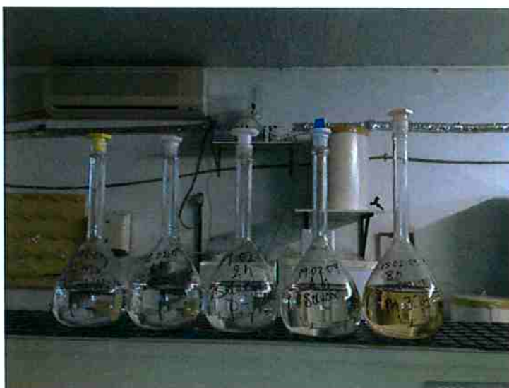
Figura 23 - Aspecto da solução de ácido acético após ensaios de perda de massa com injeção de O_2 , da esquerda para direita, por tempos de 30min, 1h, 2h, 4h e 8h. Nota-se que para o tempo de 8h a solução apresentou coloração marrom, típica da presença de Ions de ferro. No caso dos ensaios sem injeção de O_2 , as soluções utilizadas, mesmo após 8h de imersão, mantiveram-se incolores, isto é, sem nenhuma alteração da cor devido a dissolução do aço.
