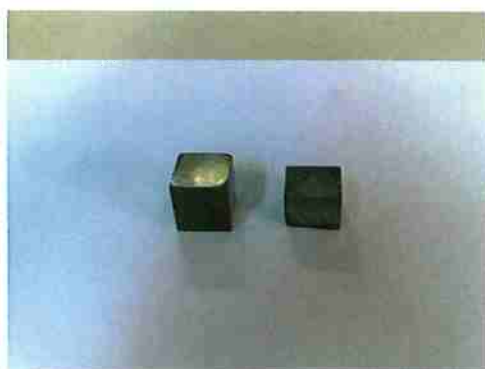
Figura 6 – Corpos-de-Prova para Ensaio de Perda de Massa e Exames Metalográficos. As dimensões destes corpos-de-prova cúbicos variaram de 1,0 a 1,6 cm de lado.
