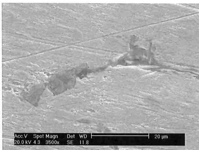
Figura 36 - Mais um detalhe da superfície após ensaio de imersão por 1 hora sem H 2 S (aumento: 3500x). Nota-se a ocorrência de corrosão ao redor das inclusões. A inclusão neste caso é de óxido de alumínio (Figura 37).
