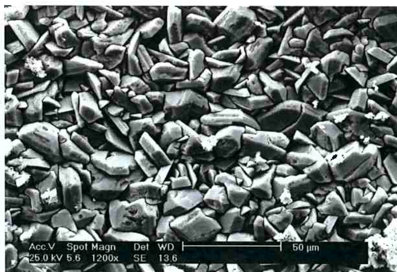
Figura 24 – Exame em MEV, com Aumento de 1200x, da Superfície da Amostra Submetida a Ensaio de Perda de Massa por 2 horas em solução 0,5% Ácido Acético, desaerada com gás Nitrogênio e Injeção de \text{H}_2\text{S} , no qual a solução apresentou-se turva durante o ensaio, devido a contaminação com oxigênio do ar. A análise por EDS mostrou tratar-se de cristais de enxofre (figura 25).
