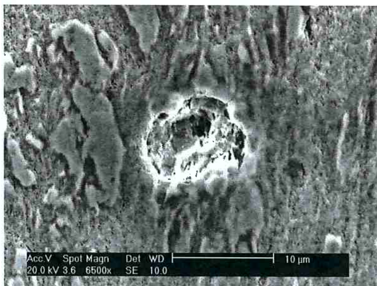
Figura 29 – Outro detalhe da superfície após perda de massa por 1 hora de imersão mostrando um pite (aumento: 6500x).
