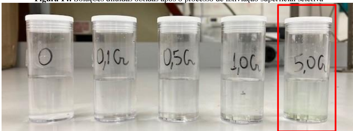
Figura 14: Soluções diluídas obtidas após o processo de lixiviação superficial seletiva
