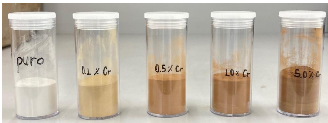
Figura 10: Pós de \text{TiO}_2 formados após as etapas de aquecimento e desaglomeração
