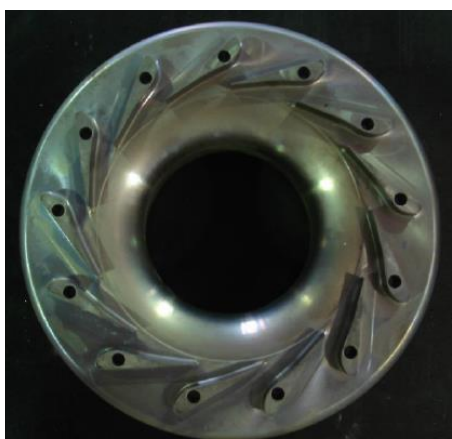
Figura 2 - Exemplo de bocal de turbina radial [2]
