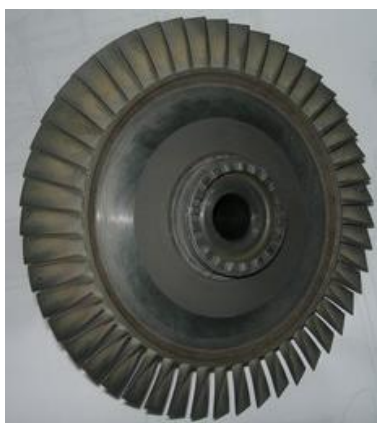
Figura 4 - Exemplo de rotor de turbina axial [4]
