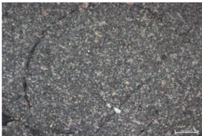
Figura 25: vista da lâmina AK-3 de estruturas perlíticas e matriz microcristalina em luz refletida e aumento de 20x.
