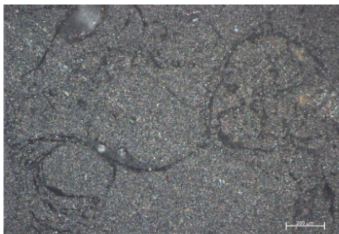
Figura 21: Lâmina AK-1 vista de estruturas perlíticas e matriz vítrea microcristalina na luz refletida na lente de 10x. Fonte: do autor.
