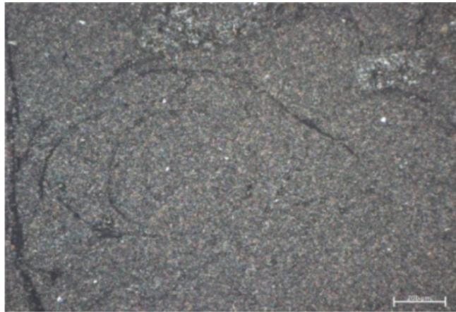
Figura 24: Lâmina AK-3 vista de estruturas perlíticas e matriz vítrea microcristalina na luz refletida na lente de 10x.
