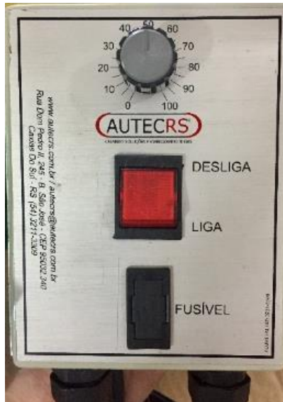
Figura 16 – exemplo de controlador de alimentador. O potenciômetro regula o ângulo de disparo do tiristor.
