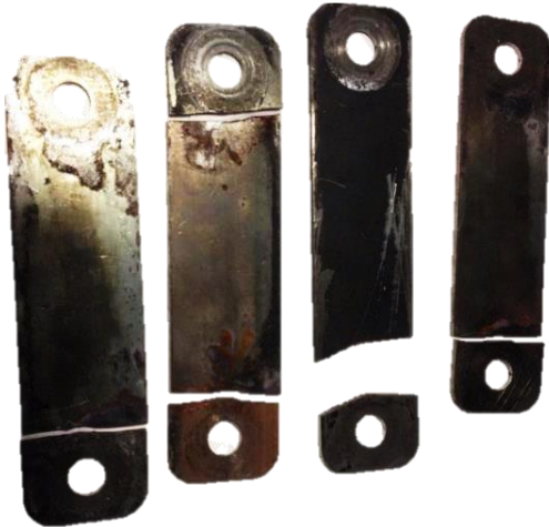
Figura 19- molas de alimentadores quebradas
