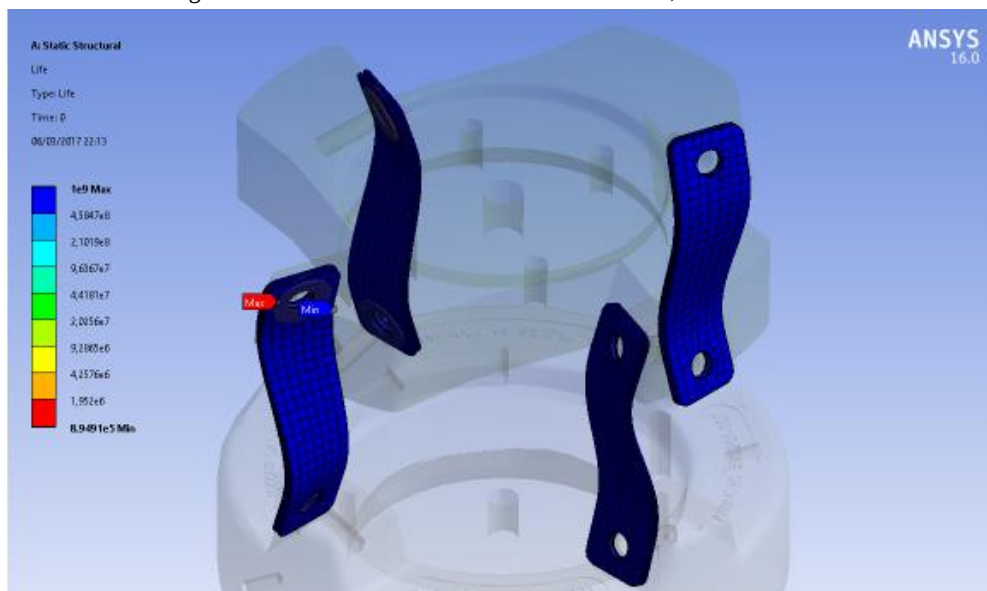
Figura 33 – SAE 1060 e Método SN: vida mínima 8,9E5 ciclos
