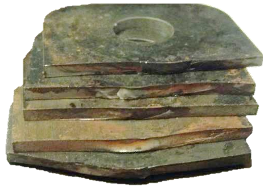
Figura 20 - seção da falha nas molas
