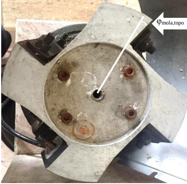
Figura 17 - ilustração do ângulo \varphi_{mola,topo}
