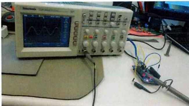
Figura 30: FRDM-K64F – Teste de Validação do Código
