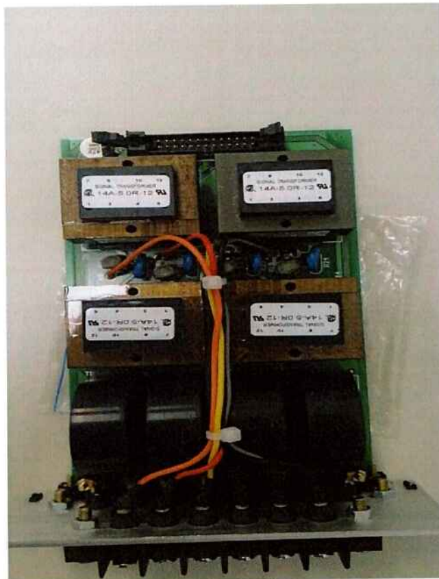
Figura 18 - Placa de condicionamento com dispositivos análogos
