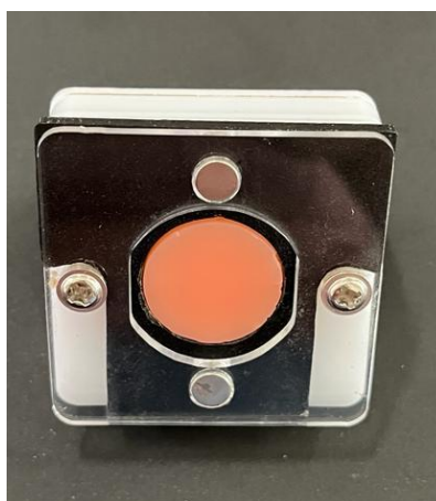
Figura 10 - Corpo de prova encaixado para análise de cor e brilho no fundo branco.
