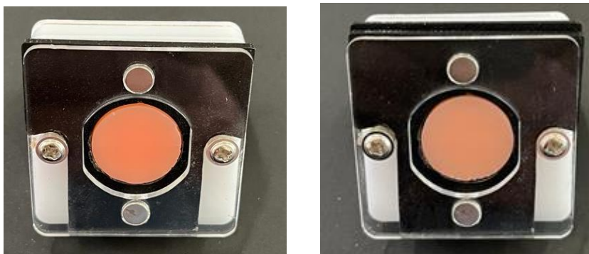
Figura 12 - Corpo de prova encaixado para análise da translucidez no fundo branco e fundo preto.
