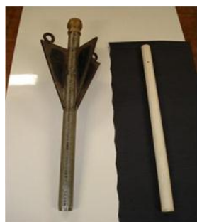
Figura 3. Amostrador tipo torpedo utilizado para coleta dos sedimentos de fundo.
