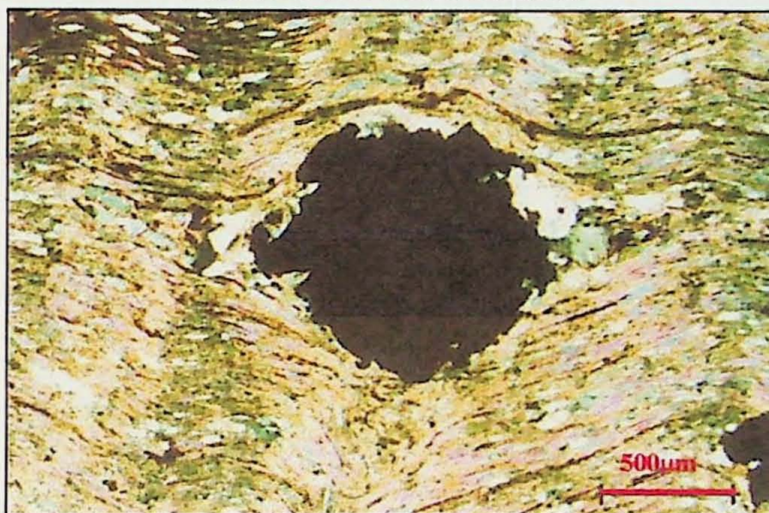
Fotomicrografia 8 - Quartzo-muscovita xisto com leitos de quartzo xisto com ilmenita, magnetita e turmalina. Aumento: 5x. Nicóis cruzados.
