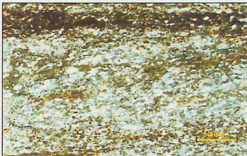
Fotomicrografia 2 - Amostra Filito Pirizal 2A - Presença de porções mais ricas em óxidos. Aumento: 5x. Nicóis cruzados.
