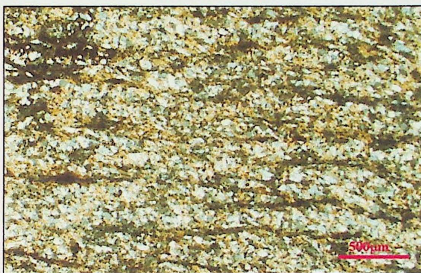
Fotomicrografia 5 - Amostra 4A - Material rico em quartzo e filossilicatos. Pode-se observar fendas com percolação de óxidos. Aumento: 5x. Nicóis cruzados.
