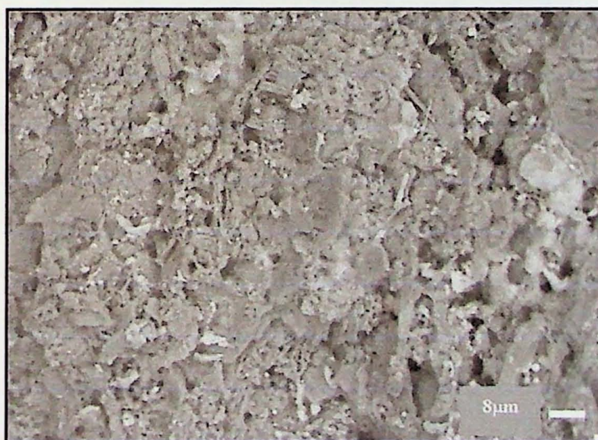
Imagem 3 - Amostra Filito Pirizal A - Material com alta porosidade.
