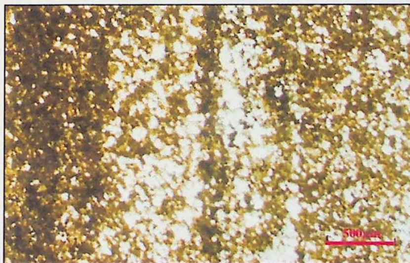
Fotomicrografia 3 - Amostra Filito Pirizal 3A - Quartzo muito fino em matriz rica em argilominerais e óxidos. Amostra muito alterada. Aumento: 5x. Nicóis cruzados.
