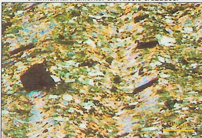
Fotomicrografia 9 - Quartzo-muscovita xisto com ilmenita, magnetita e turmalina. Aumento: 5x. Nicóis cruzados.
