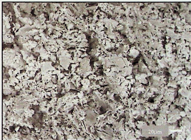
Imagem 5 - Amostra Filito Pirizal C. Local onde foi feito análise química pontual. Material de alta porosidade.
