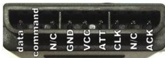
Figura 11 – Pinos do conector do controle do Playstation [10].
