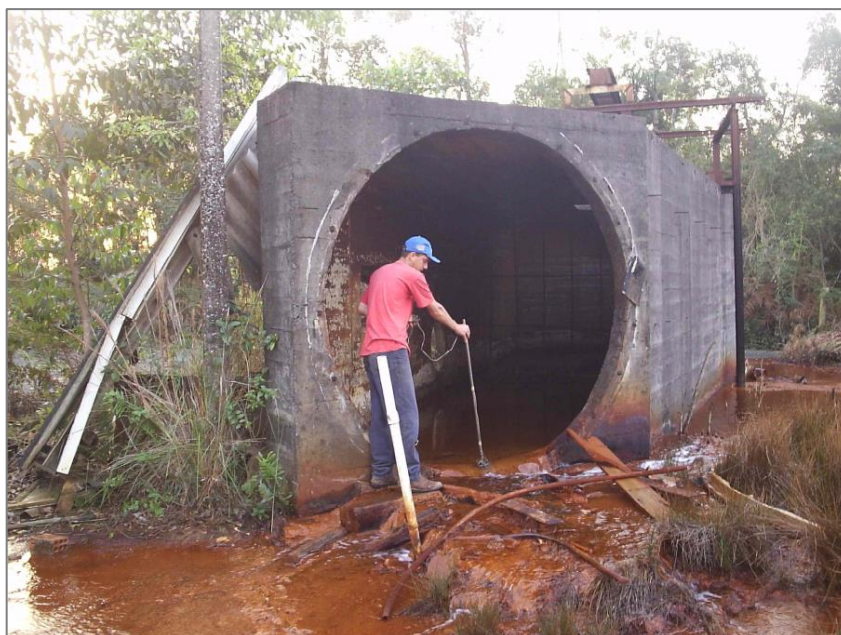
Figura 10 – Medição da vazão no poço de ventilação da mina. Retirado de DIA (2006).
