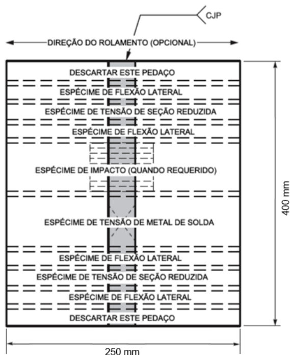
Figura 4.3 - Croqui dos corpos de prova para junta soldada (AWS D1.1)
