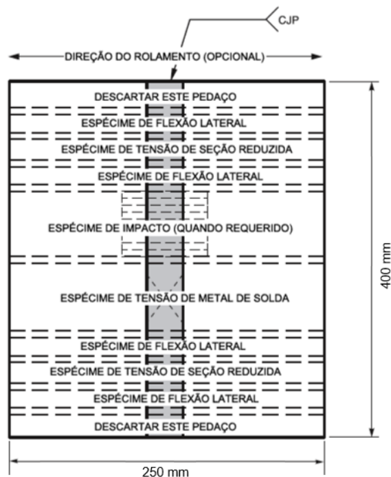
Figura 4.4 – Croqui dos corpos de prova para junta soldada (AWS D1.1)
