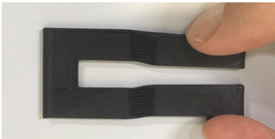
Figura 14 – Impressão 3D da região flexível em peça de ABS desenvolvida no código proposto
