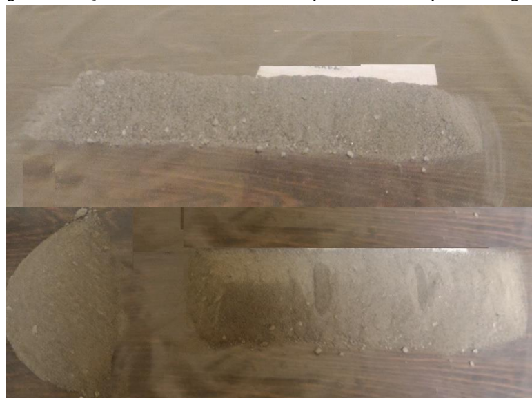
Figura 5.3 - Quarteamento da amostra RP5 pelo método de pilhas alongadas
