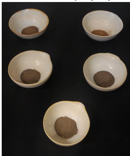
Figura 5.7 - Cadinhos contendo as amostras de rejeito para quantificação de matéria orgânica
