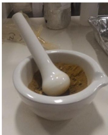
Figura 5.2 - Processo de destorroamento da Amostra RP7
