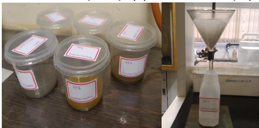
Figura 5.9 – Ensaio de solubilização - soluções preparadas em descanso e filtração após 7 dias
