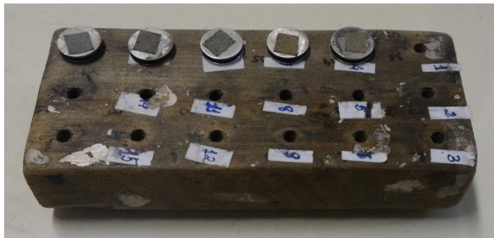
Figura 5.4 - “Stubs” contendo as amostras a serem analisadas no ensaio MEV
