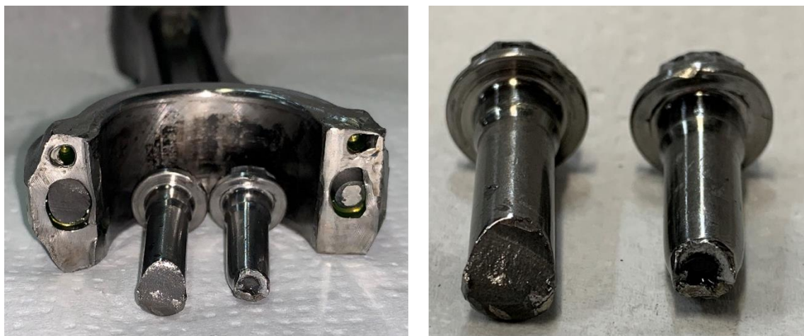
Figura 4.7 – Detalhe da parte inferior da biela e dos parafusos após a quebra (2019)
