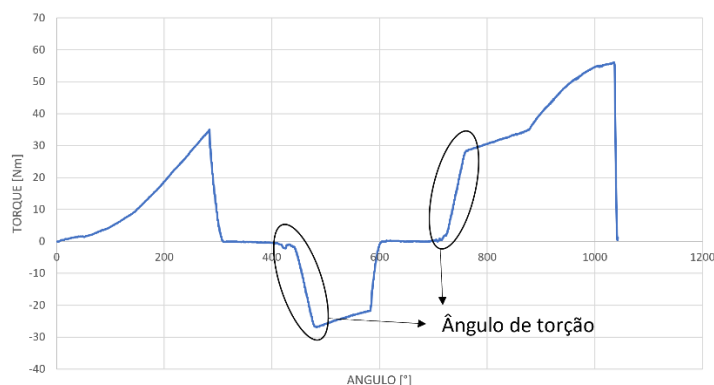
Figura 2.28 – Curva torque-ângulo para o método de aperto por controle de força
