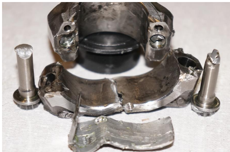
Figura 4.2 – Detalhe da parte inferior da biela e dos parafusos após a quebra (2018)
