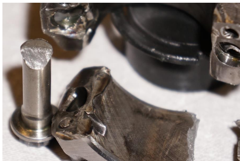
Figura 4.3 – Detalhe do parafuso após a quebra (2018)
