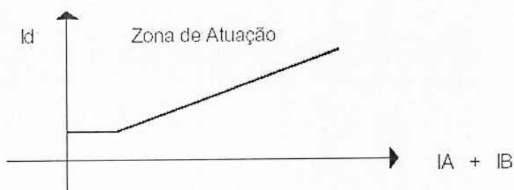
figura 4.22 - Gráfico da proteção diferencial
