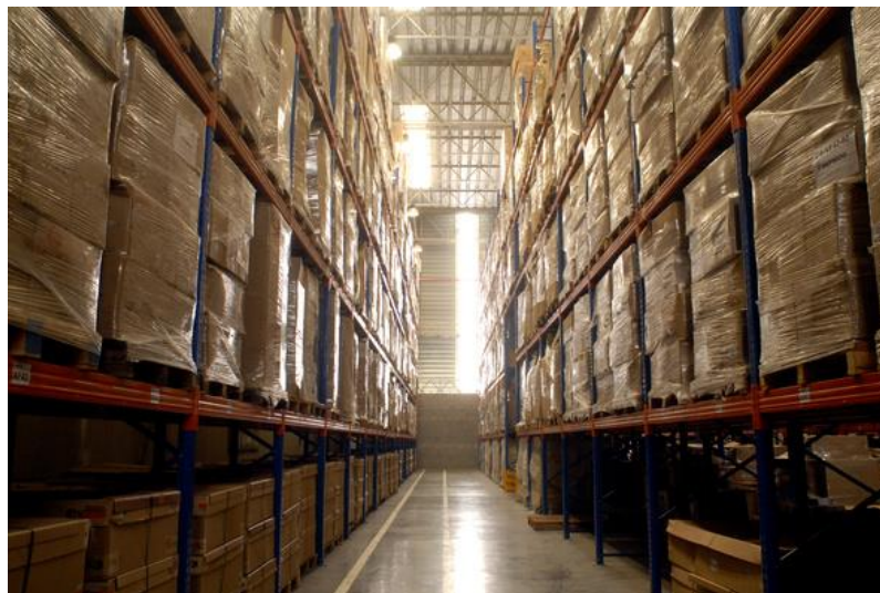
Figura 3 – exemplo de estocagem com porta-páletes
