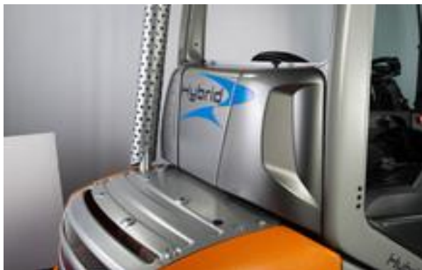
Figura 25: Contrapeso empilhadeira híbrida
