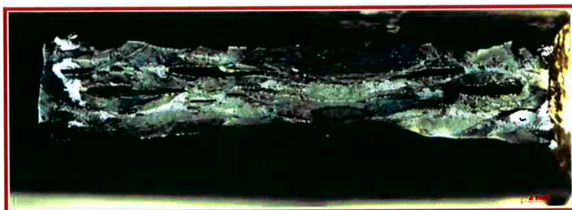
Figura 43: Delaminação apresentada na face longitudinal.
