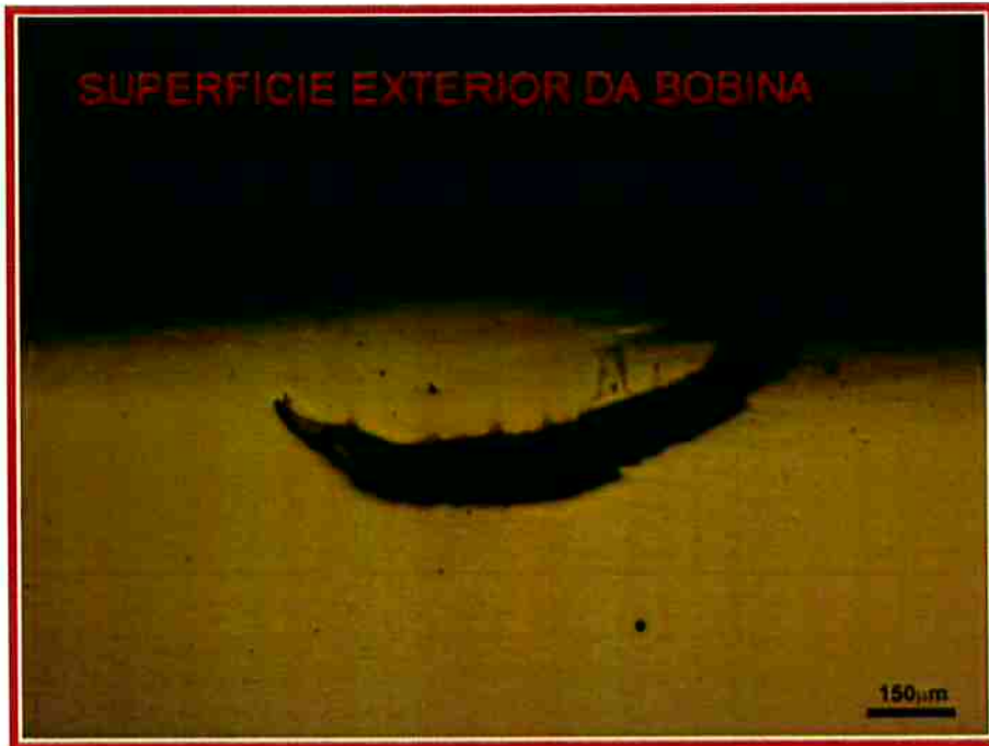
Figura 39: Blister a 100X por MO sem atacar.
