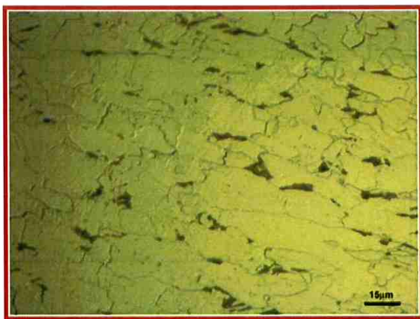
Figura 27: Microestrutura na região central da espessura da bobina.
