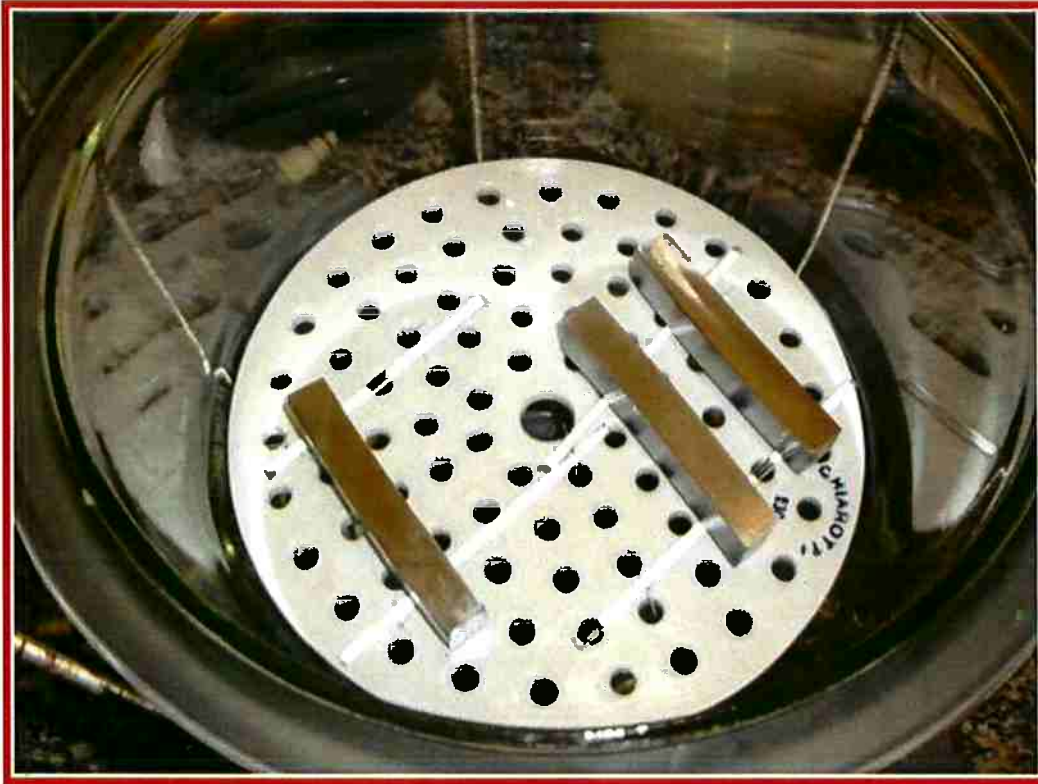
Figura 13: Disposição dos corpos de prova dentro da célula.
