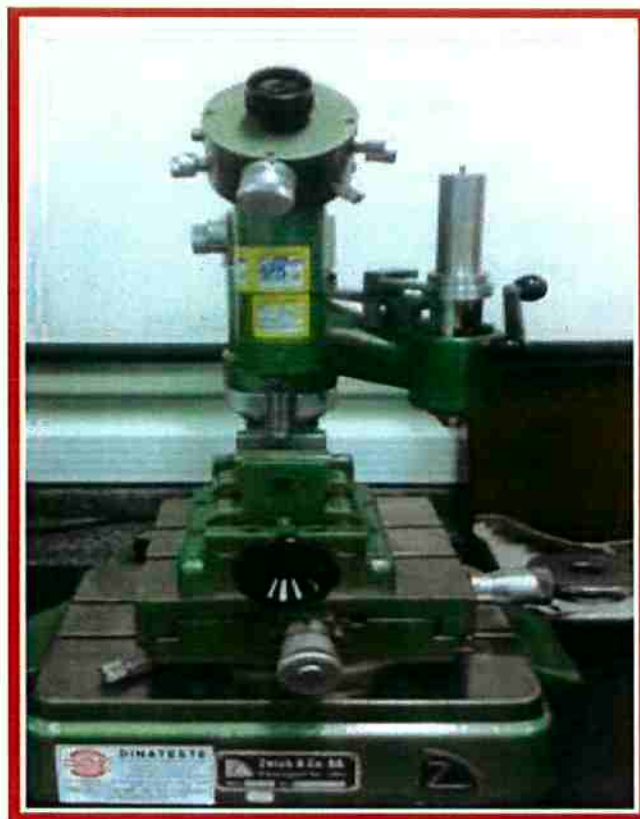
Figura 9: Microdurômetro Zwick com indentador piramidal de base quadrada.
