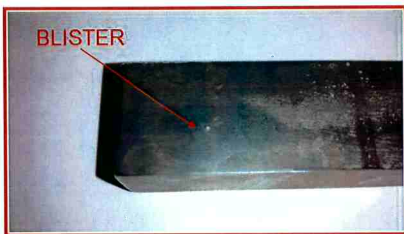
Figura 38: Blister apresentado no corpo de prova de HIC.
