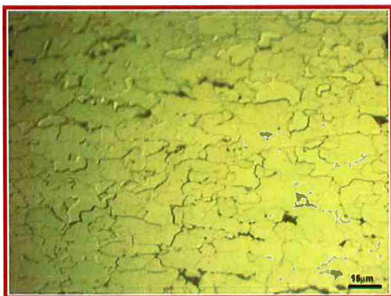
Figura 28: Microestrutura da face interior da bobina de aço microligado.
