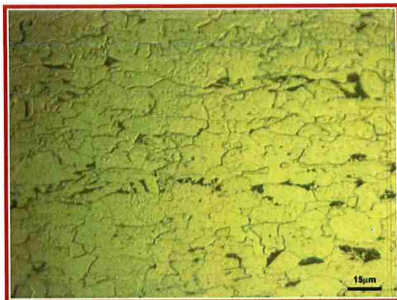
Figura 26: Microestrutura perto da face externa da bobina do aço microligado.
