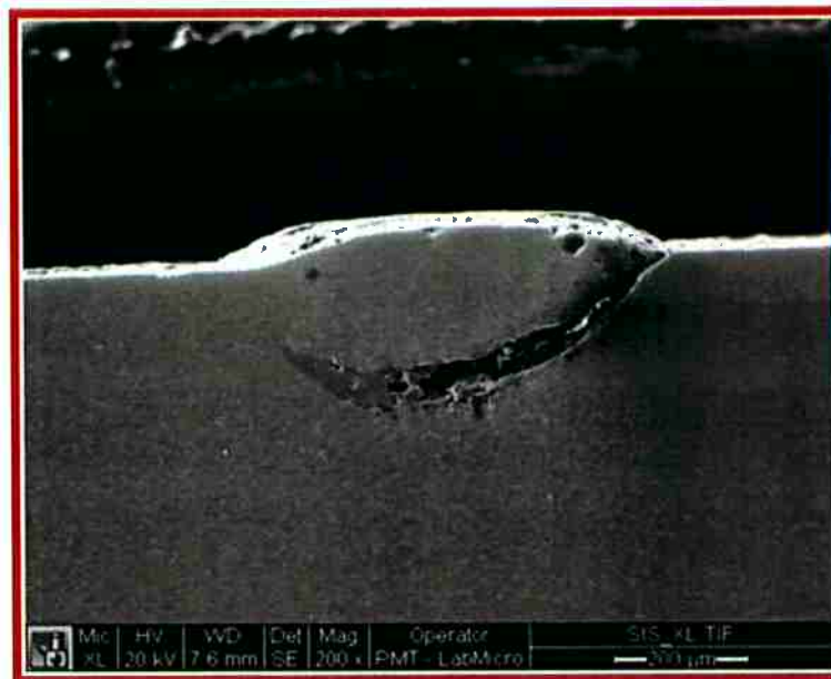
Figura 40: Forma do blister por MEV. 200X. Ataque Nital 2%
