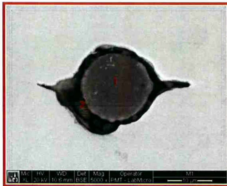
Figura 20: Inclusão de Al_2O_3 contendo Ca com forma globular.
