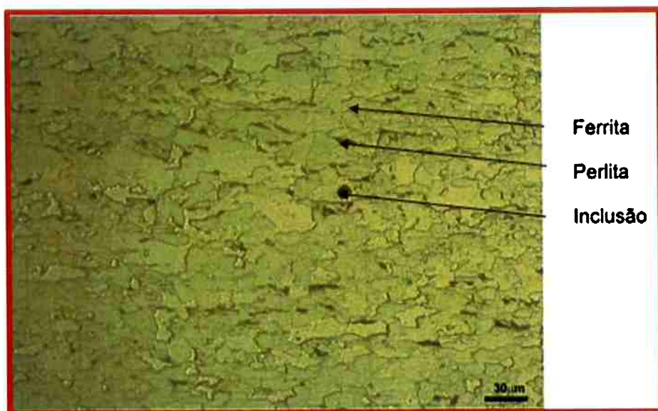
Figura 25: microestrutura do aço X65 Sour por MO.500X.
