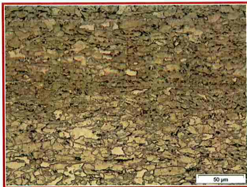
Figura 36: Linha central de segregação por MO. 500X (1).
