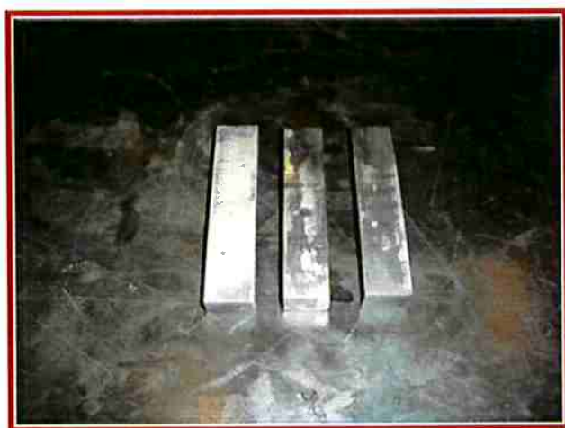
Figura 37: Corpos de prova após o ensaio de HIC.
