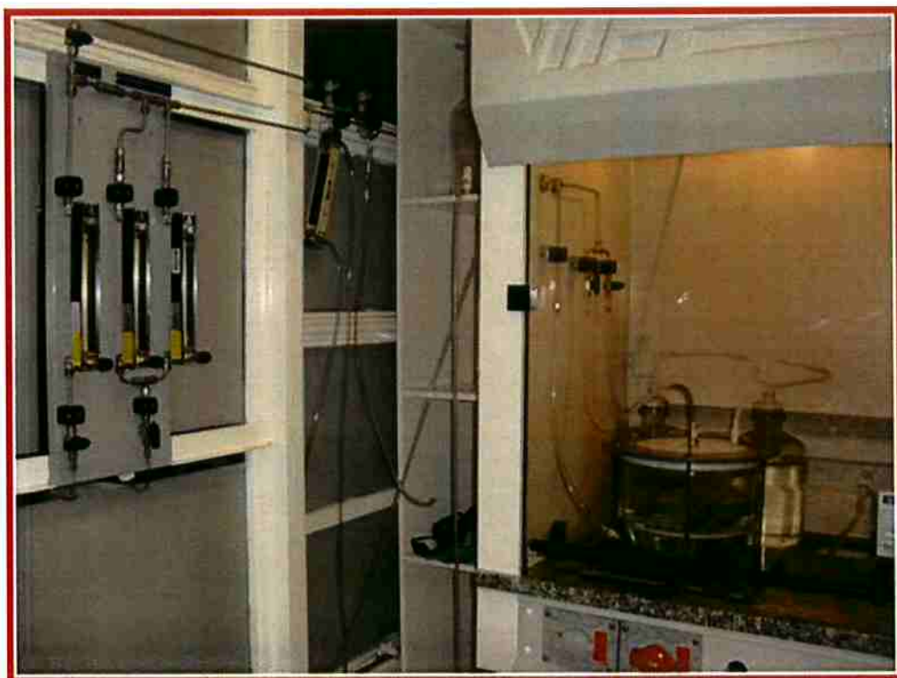
Figura 14: Arranjo para o teste de HIC no laboratório de processos eletroquímicos (LPE).
