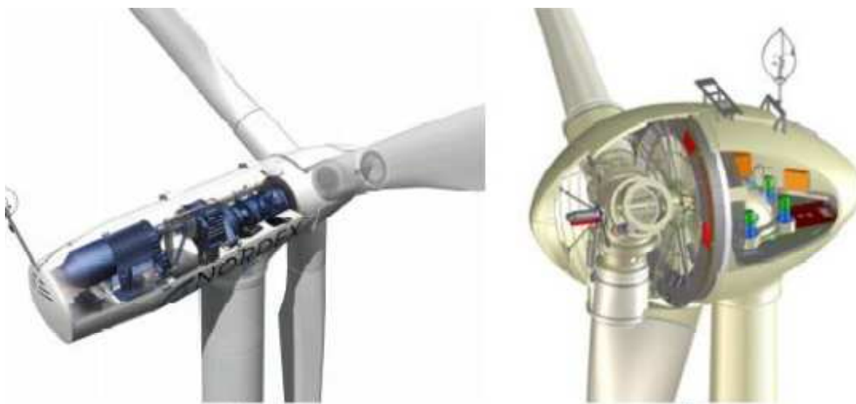
1-6: Turbina com caixa multiplicado á esquerda e sem caixa multiplicadora á direita
