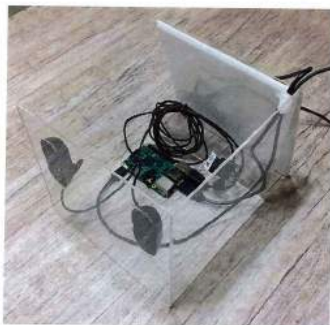
Figura 33: Produto final que conta com o computador embarcado e a câmera estereoscópica
