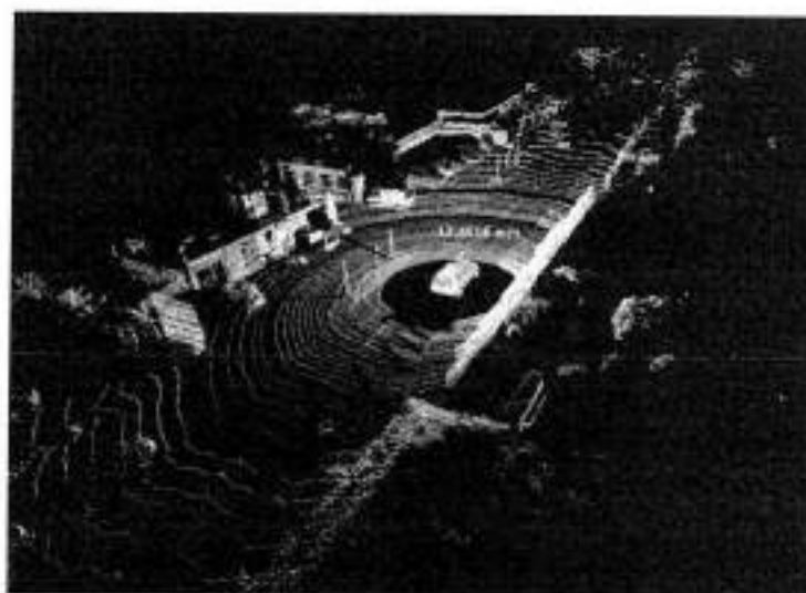
Figura 2: Modelo 3D gerado a partir de dados do LIDAR da Velodyne
