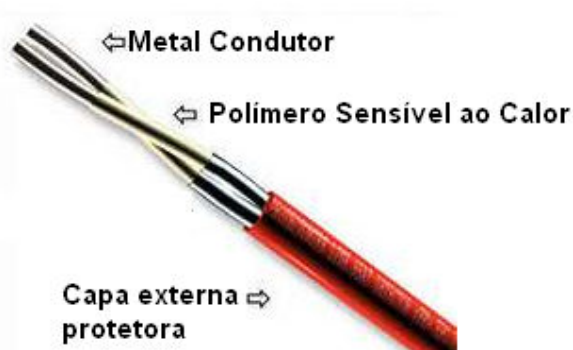
Figura 17 - Detector Linear do tipo Cabo Resistivo (PROTECTORWIRE, 2010)
