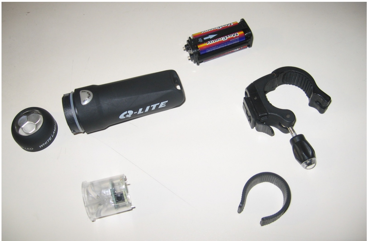
Q-Lite modelo QL-230 desmontado
