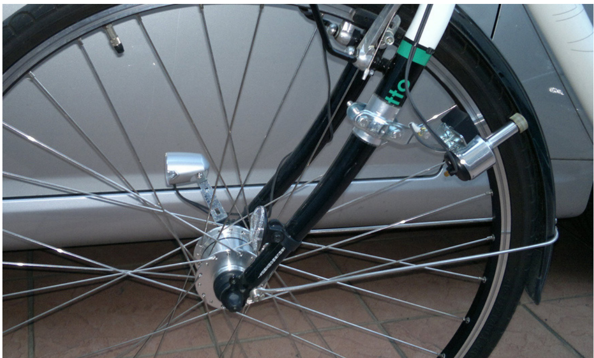
Bicicleta simultaneamente com dínamo tipo “garrafa” e de cubo. (Fonte: Flickr).
