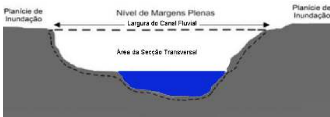
Figura 22 – Esquema representativo da área da secção transversal de um canal fluvial
