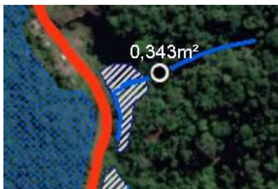
Figura 46 – Detalhe do esboço morfológico da rede de drenagem antropogênica (canal fluvial nº1)
