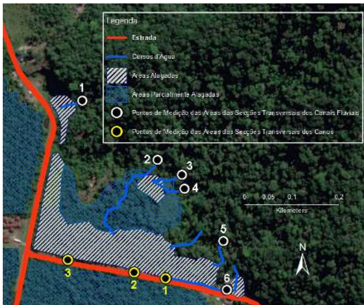
Figura 33 – Mapa dos pontos de medição das áreas das secções transversais dos cursos d'água e dos canos construídos nos pontos de cruzamento com a estrada
