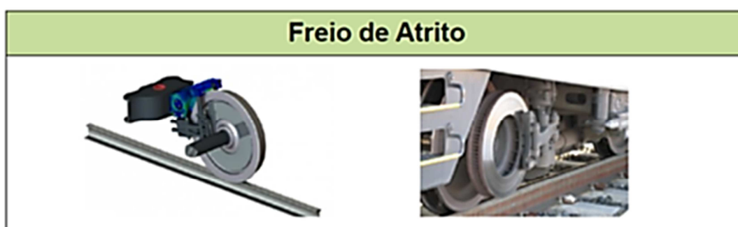
Figura 9 - Ilustração do sistema de frenagem mecânica com freio de atrito Fonte: (SIEMENS, 2013)
