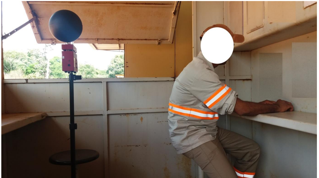
Figura 19 - Avaliação de calor na área de vivência (local de descanso Aux. Agrícola)
