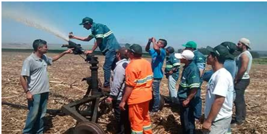
Figura 12 - Operador de moto bomba de aplicação de vinhaça ajustando vazão do equipamento
