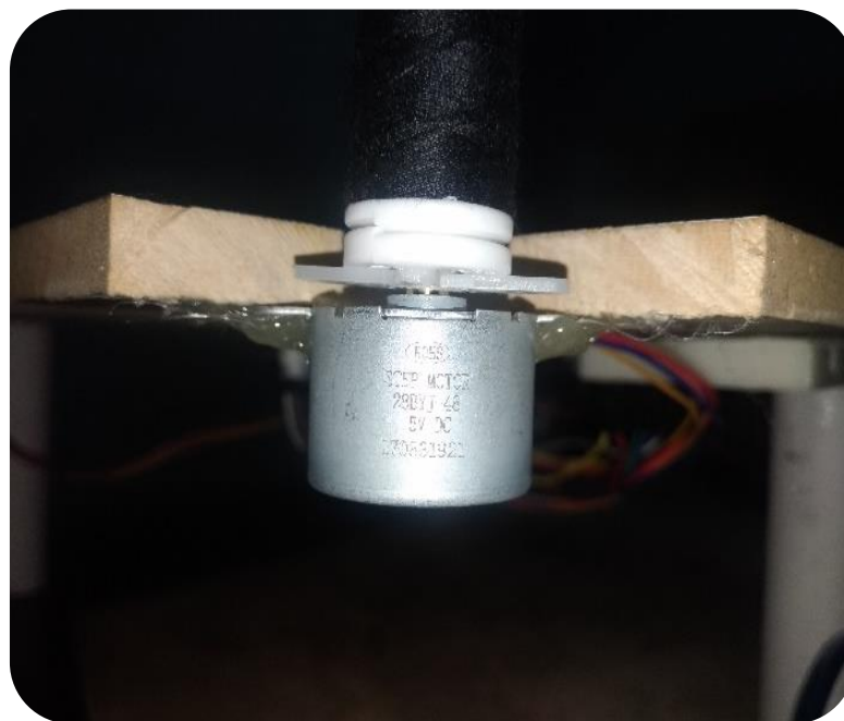
Figura 23 - Fixação Hélice/Carretel – Eixo do Motor.
