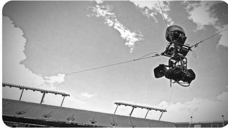
Figura 8 - Conceito da Spider Cam baseado em CDPRs
