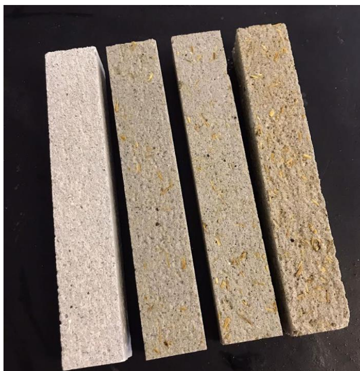
Figura 10 – Corpos de prova do Traço 1 ao Traço 4 (esquerda para direita)
