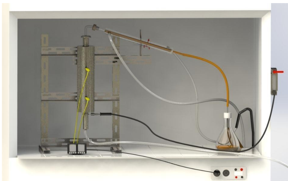
Figura 3.18 - Gaseificador de pirólise tipo batelada utilizado na pirólise lenta da CCC
