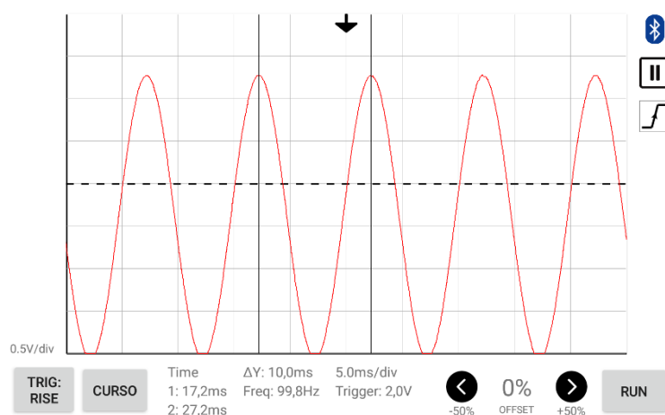
Figura 46: Onda senoidal de 100Hz visualizada no aplicativo com escala de 5ms/divisão.
