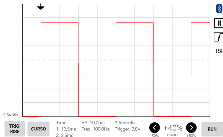
Figura 27: Onda quadrada de 100Hz visualizada no aplicativo com escala de 2,5ms/divisão.
