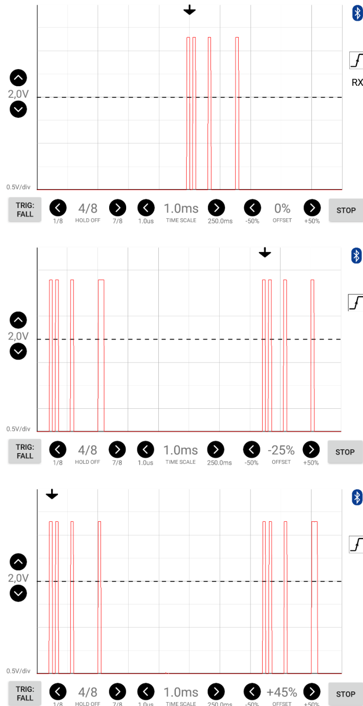
Figura 9: Imagens de telas do aplicativo exemplificando o uso da função de offset para um mesmo sinal de entrada, com seu valor em 0% (superior), -25% (centro) e +45% (inferior).
