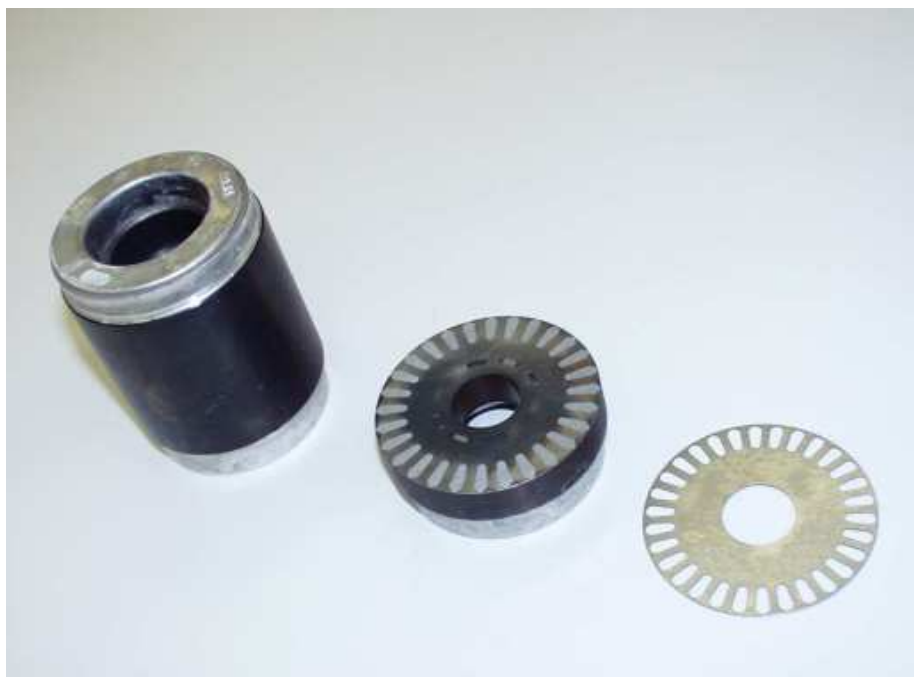
Figura 21 - Rotor, corte longitudinal e lâmina
