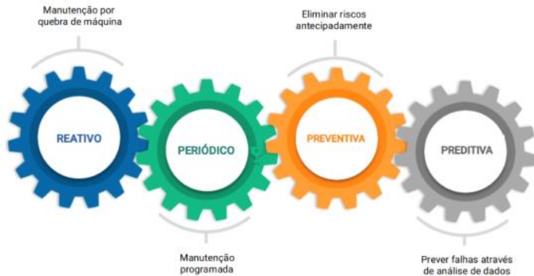
Figura 4 - Tipos de manutenção de acordo com o momento em que é realizada
