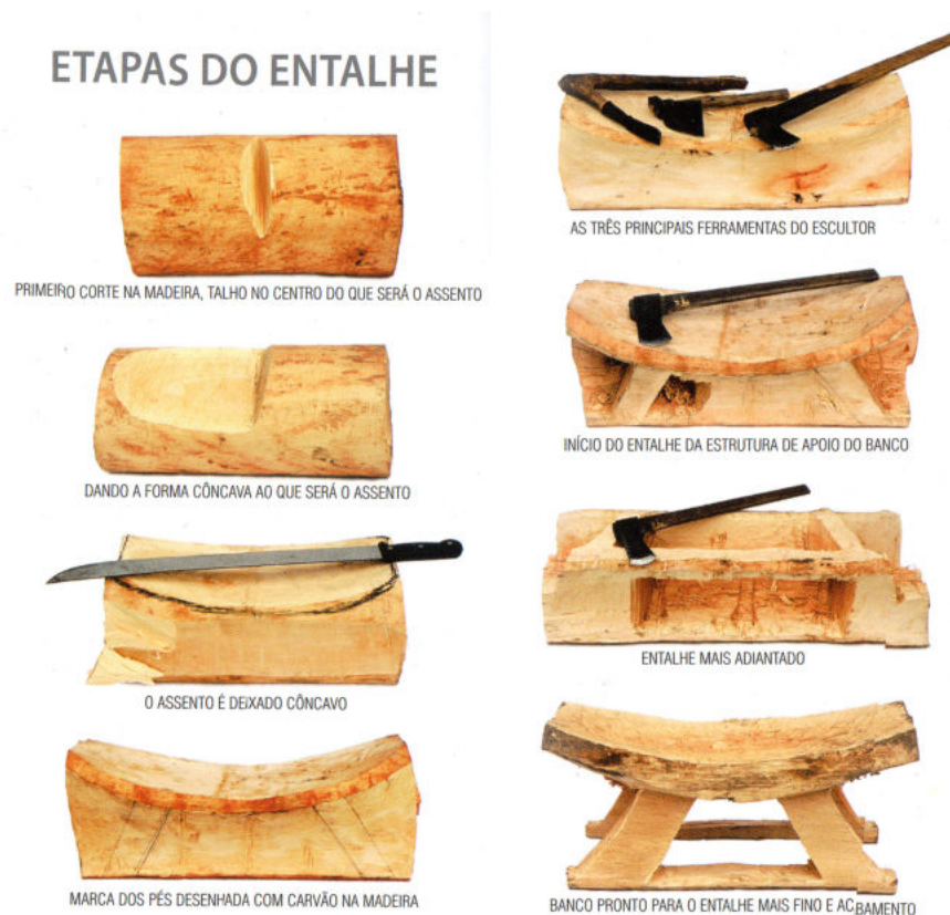
Figura 8: Etapas de construção do Kumurô, banco ritualístico do povo Tukano. Fonte: FOIRN (2015)
