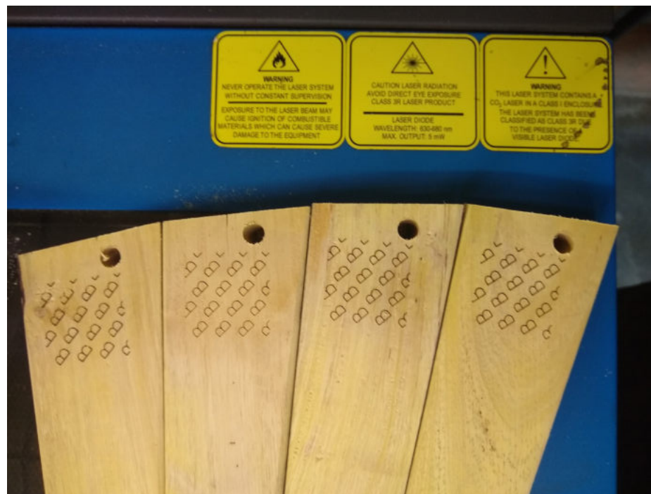
Figura 34: Banquinho 3G - Peças gravadas a laser. Fonte: do autor.
