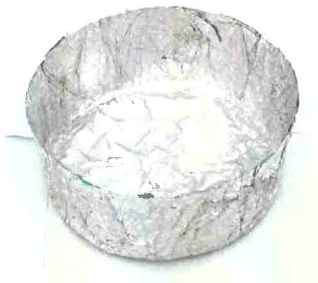
Figura 39 – Porta amostra fabricado com folha de alumínio.
