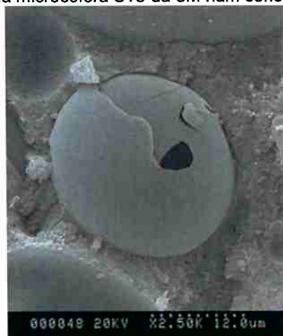
Figura 4 - Micrografia de uma microesfera S15 da 3M num concreto leve de cimento Portland
