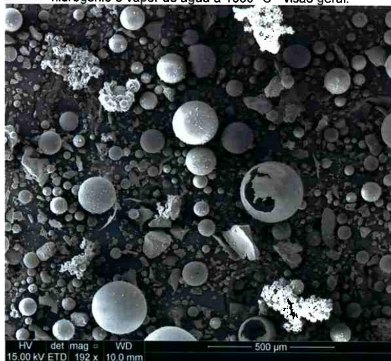
Figura 74 – Microscopia eletrônica de varredura da frita 2 preparada em atmosfera mista de hidrogênio e vapor de água a 1350° C - visão geral.
