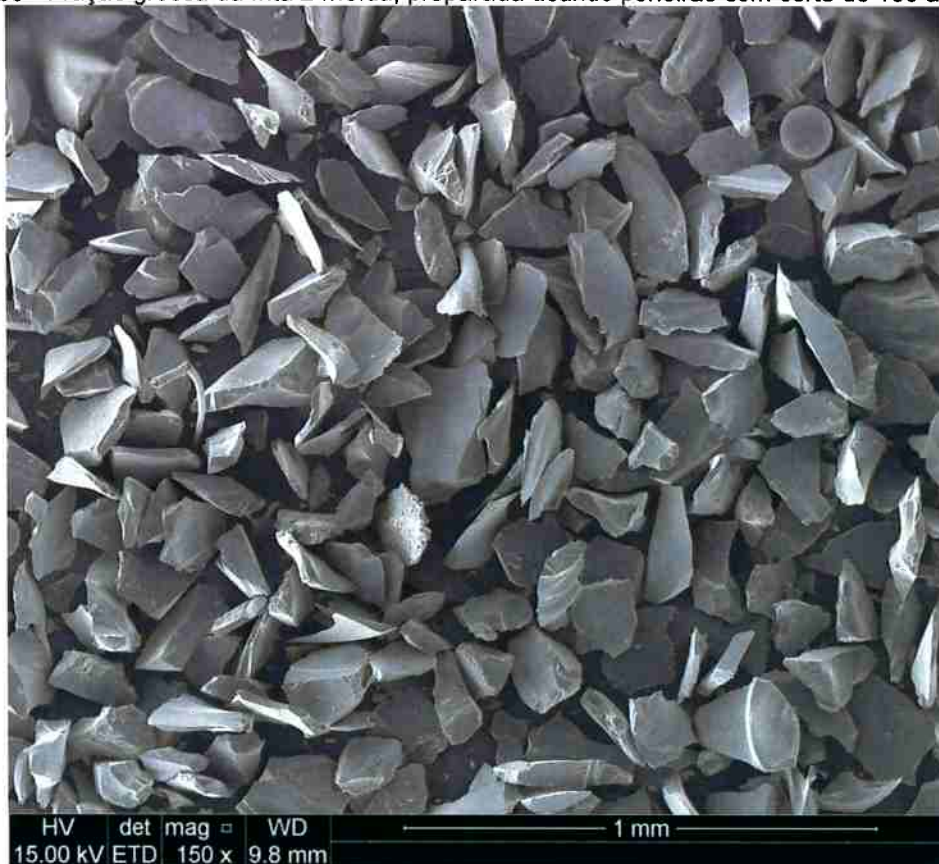
Figura 55 - Fração grossa da frita 2 moída, preparada usando peneiras com corte de 180 a 250 \mu\text{m}
