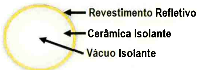
Figura 25 – Desenho esquemático de microesfera oca utilizada como aditivo para proporcionar isolamento térmico em tintas.
