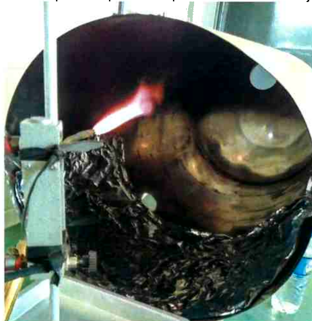
Figura 47 - Aparato experimental para os ensaios em maçarico
