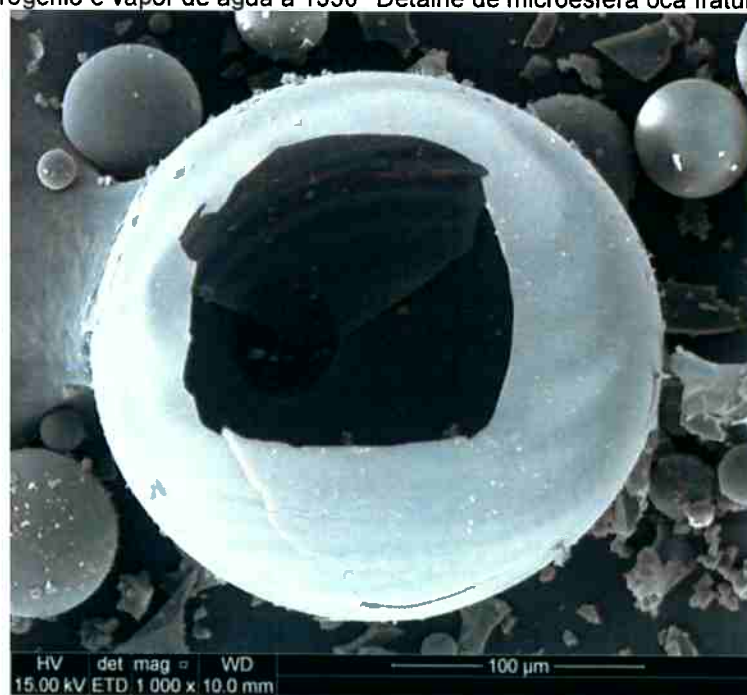
Figura 75 - Microscopia eletrônica de varredura da frita 2 preparada em atmosfera mista de hidrogênio e vapor de água a 1350° Detalhe de microesfera oca fraturada.
