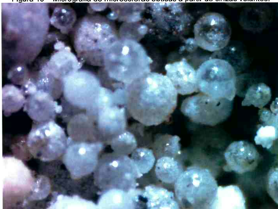
Figura 19 – Micrografia de microesferas obtidas a partir de cinzas volantes.
