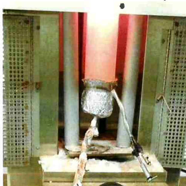
Figura 46 – Forno tubular em funcionamento com alimentação de hidrogênio.
