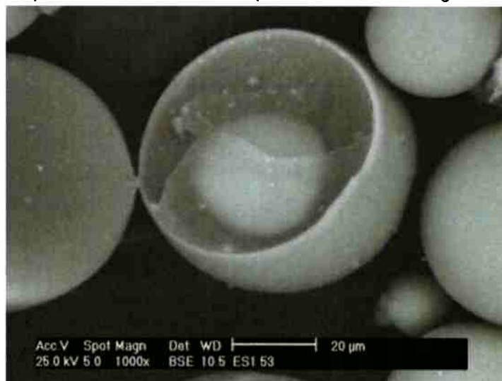
Figura 14 – partícula com núcleo não expandido devido ao alto gradiente térmico
