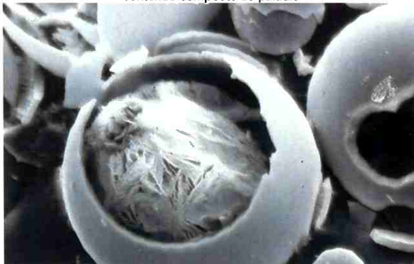
Figura 32 – Micrografia eletrônica de esfera oca porosa contendo composto de paládio
