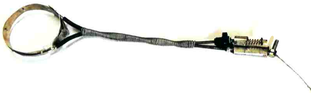
Figura 40 – Abraçadeira para fixação do porta-amostra ao tubo de alumina.
