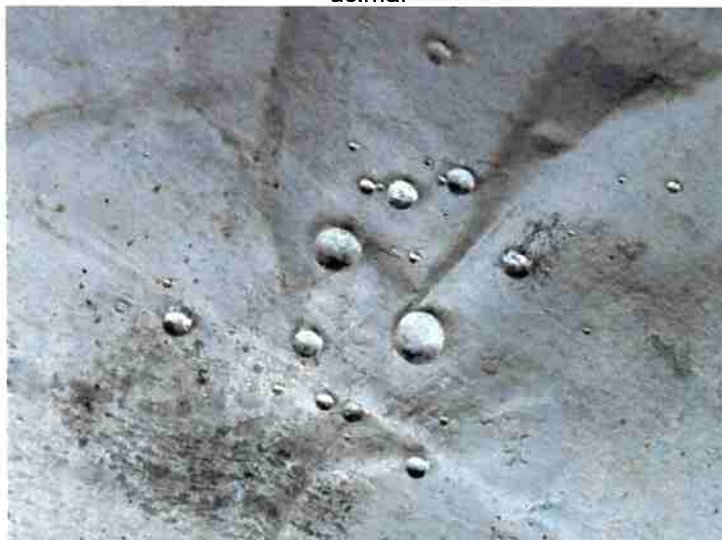
Figura 49 - Sílica hidrofóbica (diatomita) em papel de filtro preparada conforme o método descrito acima.
