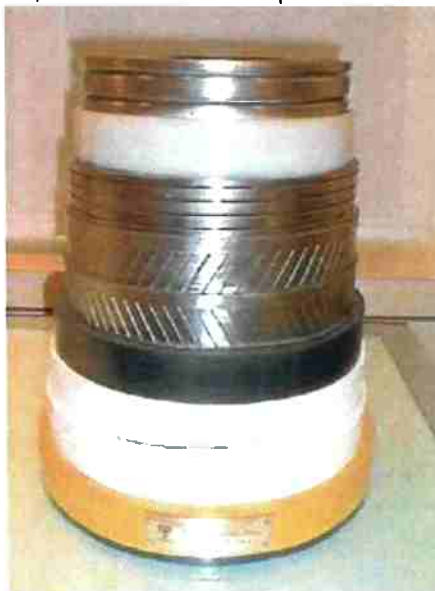
Figura 23 – Riser flexível, contendo fitas de espuma sintática como isolante térmico
