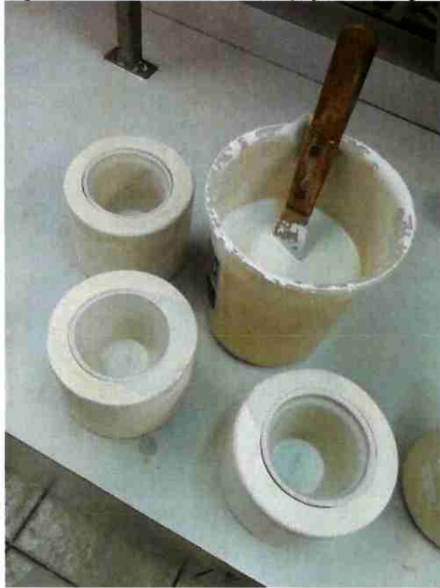
Figura 34 - Barbotina e moldes com peças em secagem
