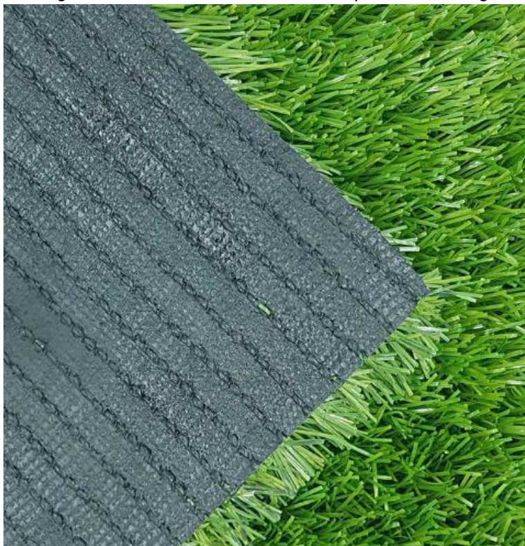
Figura 2 – Grama sintética com o componente backing .
