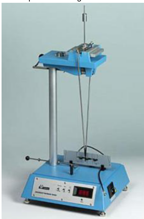
Figura 8 – Durômetro de pêndulo König e Persoz modelo HA-5854.
