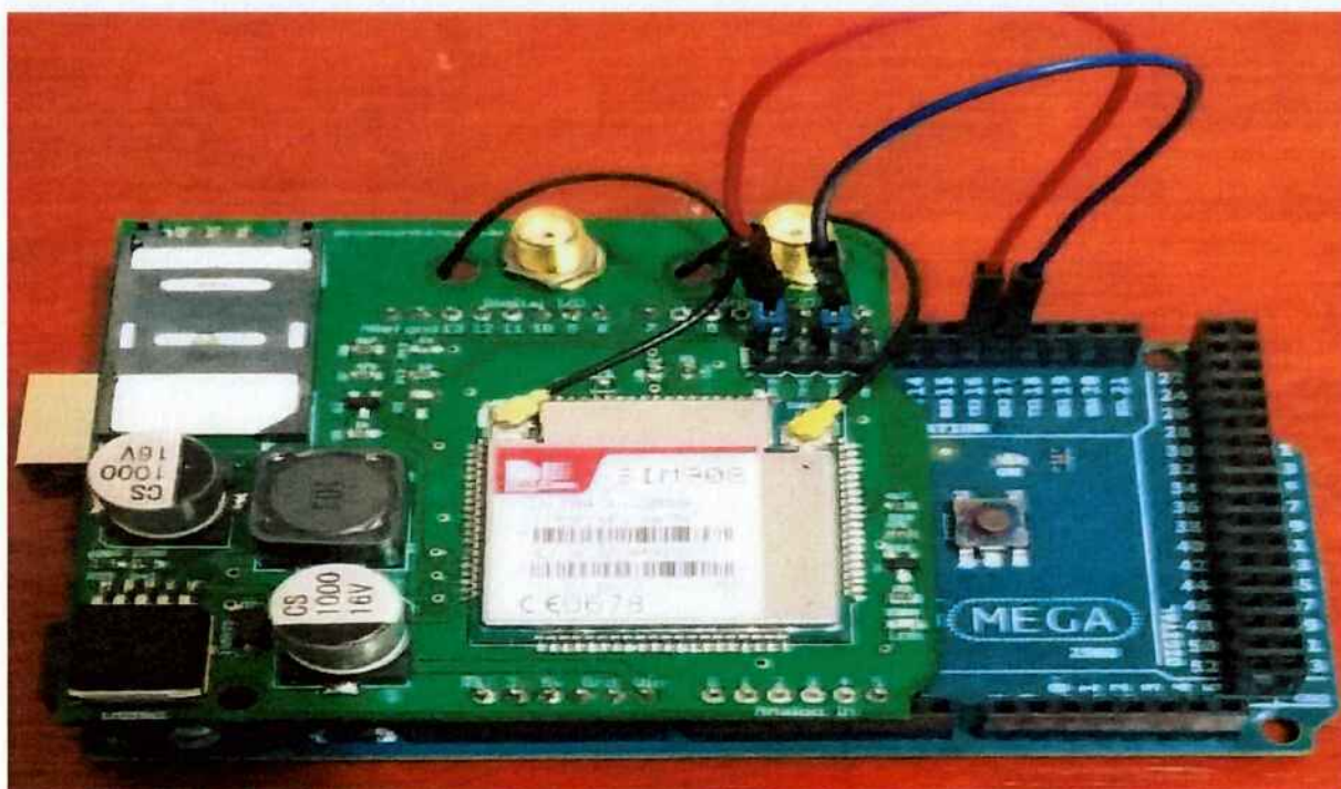
Figura 12 - Conexão do Shield com o Arduino Mega 2560 Fonte: O Autor
