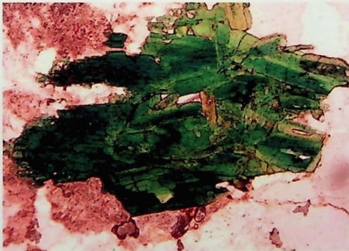
(o) Agregado de cristais de egrina, alguns zonados com bordas mais claras, alaranjadas e núcleos esverdeados dos álcali-feldspato granitos protomiloníticos. Amostra MR-06, polarizador inferior. Lado maior da foto 2,05 mm.
