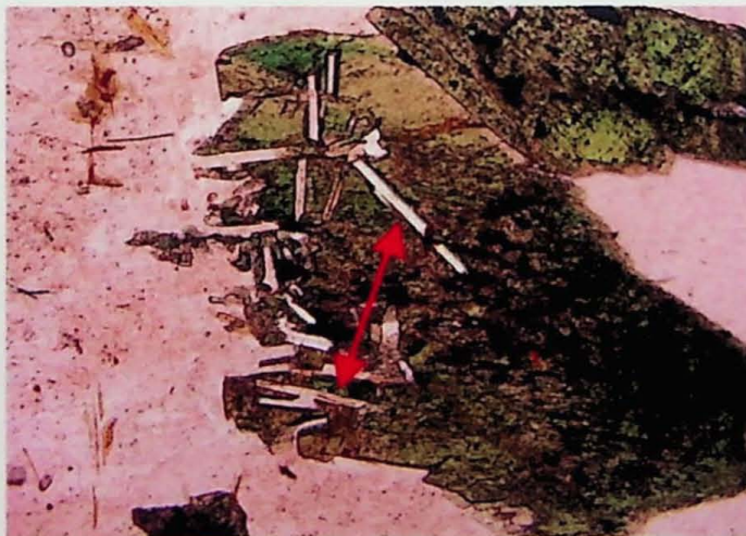
(c) Cristal de egirina apresentando intercrescimento com albita ripiforme (destaque), além de inclusões de magnetita e ilmenita (parte central) dos álcali-feldspato granitos equi-inequigranulares. Amostra MR-01A, polarizador inferior. Lado maior da foto 1,31 mm.
