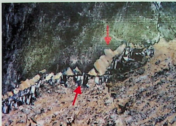
(e) Detalhe de bordas de albita pós-magmáticas do tipo "swapped rims" ao longo do contato entre 2 cristais de feldspato potássico dos álcali-feldspato granitos equi-inequigranulares. Amostra MR-01A, polarizadores cruzados. Lado maior da foto 2,05 mm.
