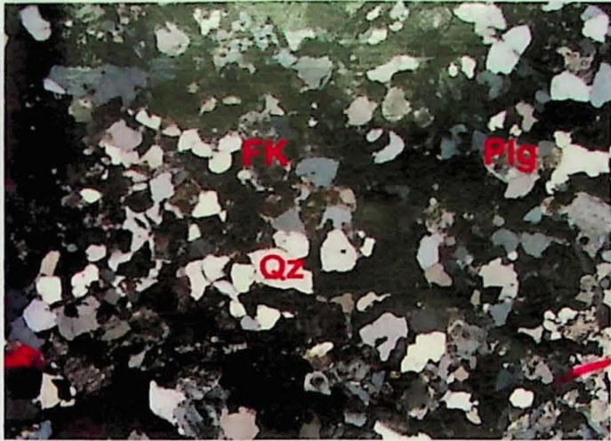
(i) Aspecto textural dos biotita granitos equigranulares, com cristais de feldspato potássico (FK), plagioclásio (Plg) e quartzo (Qz). Biotita é rara. Amostra MR-19C, polarizadores cruzados. Lado maior da foto 5,24 mm.
