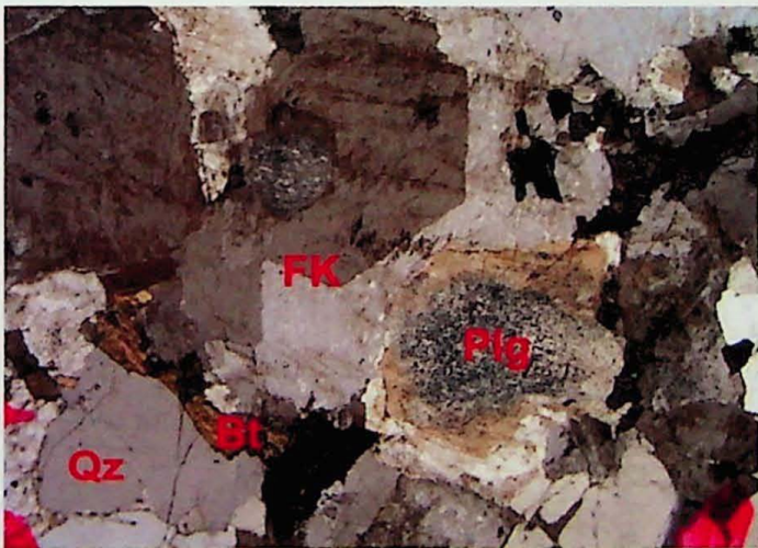
(c) Aspecto textural dos biotita granitos inequigranulares, com cristal maior de feldspato alcalino (FK), plagioclásio (Plg), quartzo (Qz) e biotita (Bt). Amostra MR-30, polarizadores cruzados. Lado maior da foto 5,24 mm.
