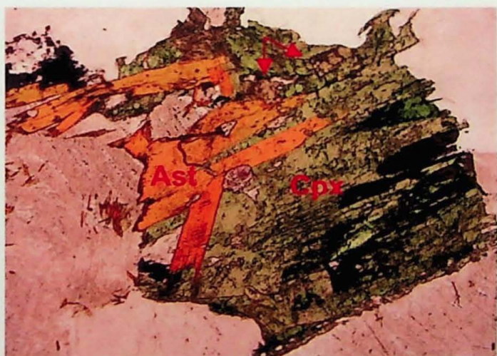
(k) Cristal de egrina ( Cpx ) parcialmente substituída por anfibólio sódico, com cristais de astofilita ( Ast ) associados; dos álcali-feldspato granitos equi-inequigranulares. Notar inclusões da egrina mais clara na parte superior direita da foto (em destaque). Amostra MR-01A, polarizador inferior. Lado maior da foto 3,27 mm.
