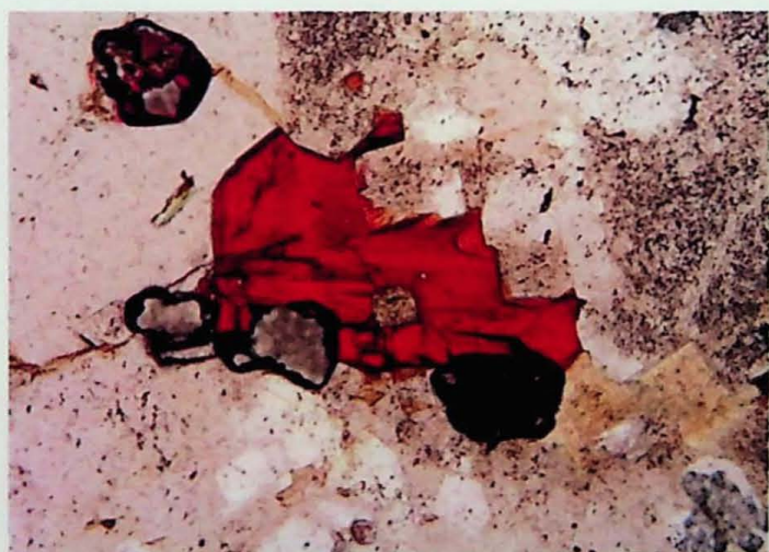
(s) Cristal subédrico laranja-avermelhado de neptunita dos álcali-feldspato granitos protomiloníticos. Notar inclusão de zircão. Amostra MR-06, polarizador inferior. Lado maior da foto 0,65 mm.
