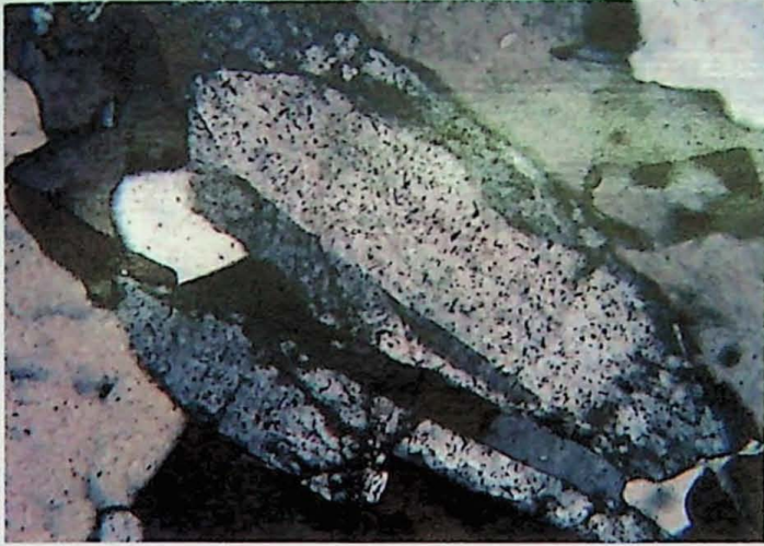
(m) Cristais euédricos zonados de um silicato de Na-Zr (cor de interferência cinza médio a escuro, relevo alto) dos álcali-feldspato granitos equi-inequigranulares. Amostra MR-26, polarizadores cruzados. Lado maior da foto 0,65 mm.
