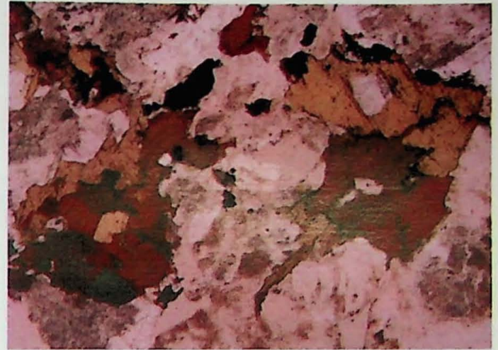
(j) Placas subédricas de biotita marrom-esverdeado a amarelo dos biotita granitos equigranulares. Notar cristais subédricos a anédricos de magnetita associados às bordas. Amostra MR-19B, polarizador inferior. Lado maior da foto 2,05 mm.
