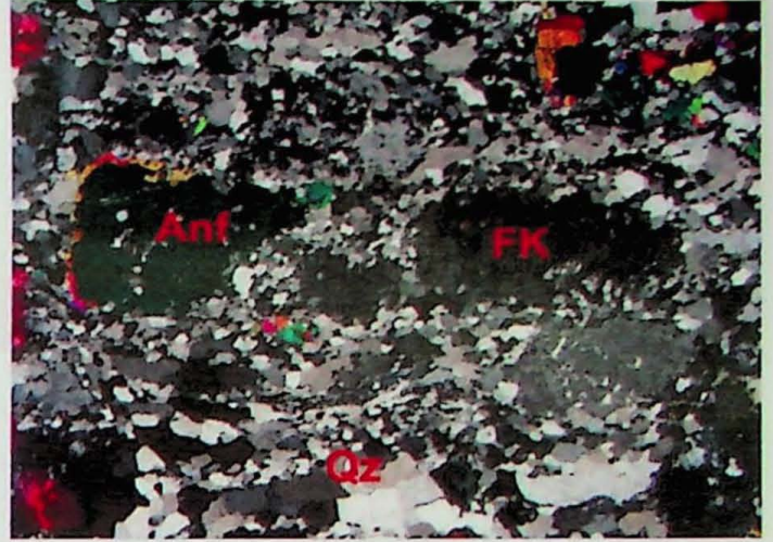
(n) Aspecto textural dos álcali-feldspato granitos protomiloníticos com porfiroclastos de feldspato potássico (FK) e anfibólio sódico (Anf) manteado por egrina nas bordas e envoltos por matriz de quartzo recristalizado (Qz). Amostra MR-03, polarizadores cruzados. Lado maior da foto 6,55 mm.
