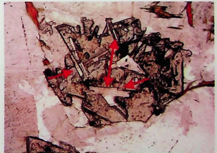
(d) Cristal de zircão apresentando intercrescimento com albita ripiforme (destaque) dos álcali-feldspato granitos equi-inequigranulares. Notar cristais alaranjados de astrofilita na parte superior da foto. Amostra MR-01A, polarizador inferior. Lado maior da foto 1,31 mm.
