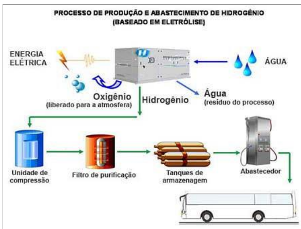
Figura 5: Processo de produção e abastecimento de hidrogênio
