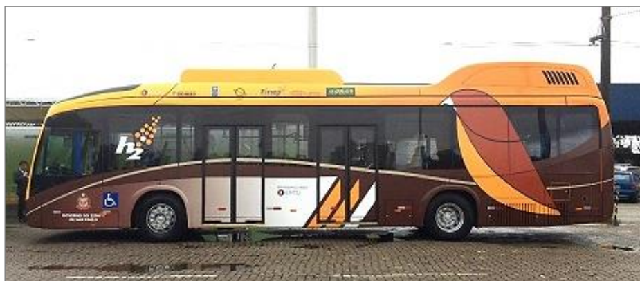
Figura 4: Ônibus brasileiro movido a hidrogênio
