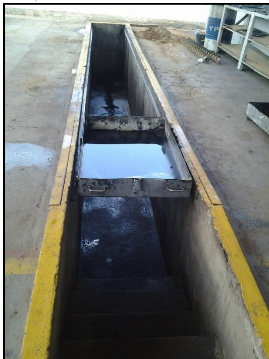
Figura 16 –Bandejas de acondicionamento de óleo lubrificante usados
