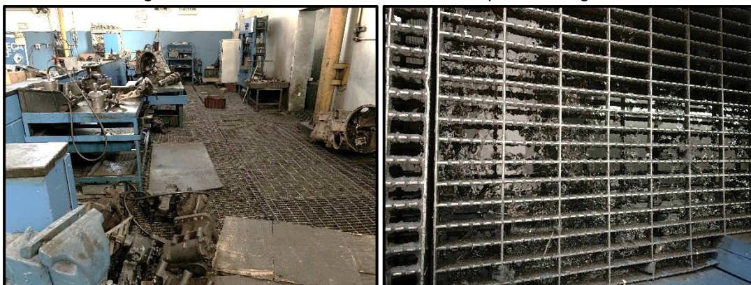
Figura 17 – Piso enxarcado com óleo sobreposto com grade.
