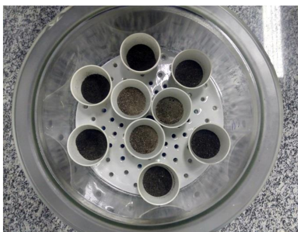
5- Amostras retiradas mufla a 350 °C
