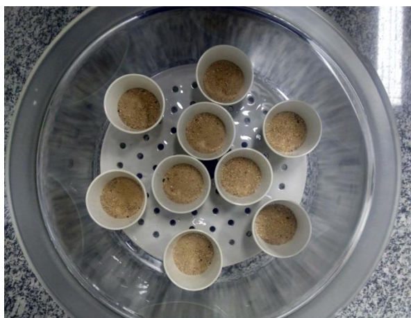
9- Amostras retiradas da mufla a 550 °C
