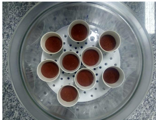
8- Amostras retiradas da mufla a 490 °C
