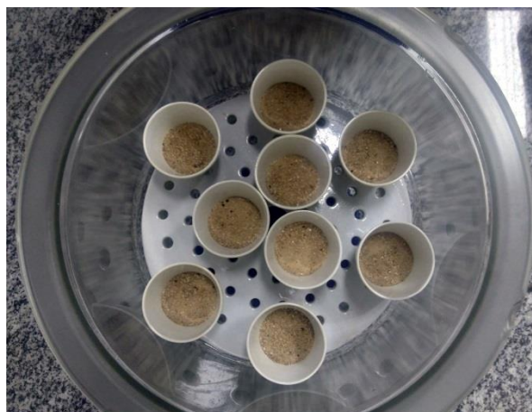
8- Amostras retiradas da mufla a 490 °C
