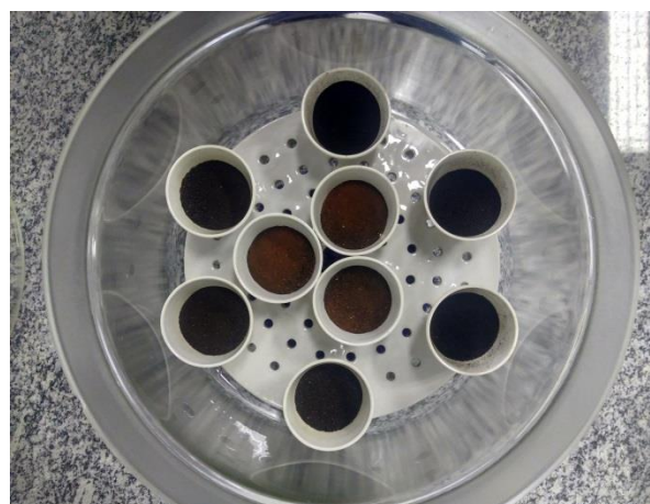
4- Amostras retiradas da mufla a 300 °C
