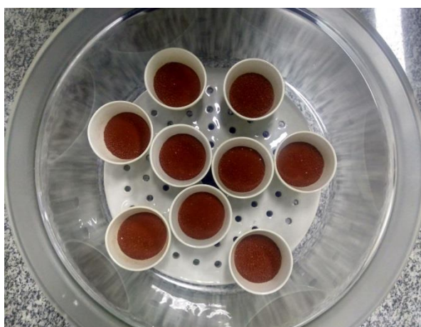
9- Amostras retiradas da mufla a 550 °C
