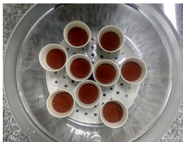
10- Amostras retiradas da mufla a 650 °C
