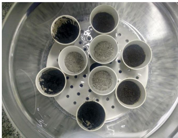
1- Amostras retiradas da mufla a 100 °C
