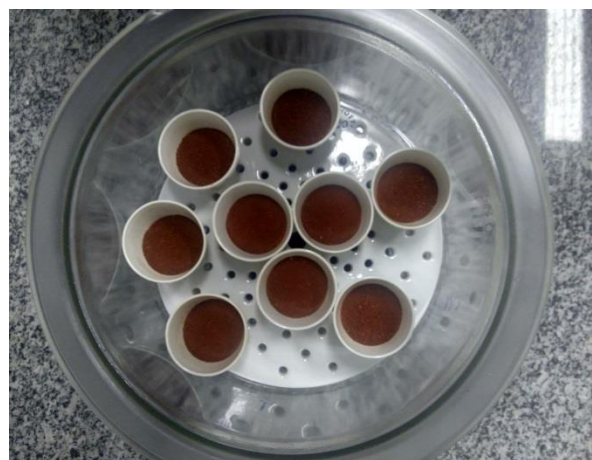
6- Amostras retiradas da mufla a 400 °C
