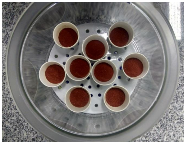
7- Amostras retiradas da mufla a 455 °C
