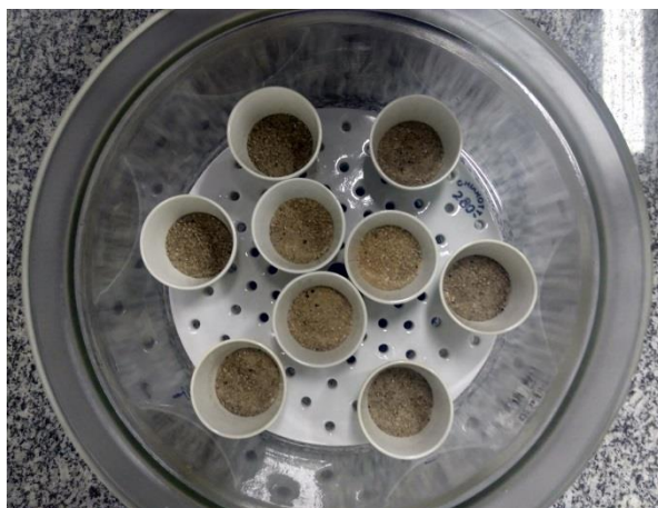
7- Amostras retiradas da mufla a 455 °C
