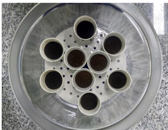
3- Amostras retiradas da mufla a 250 °C
