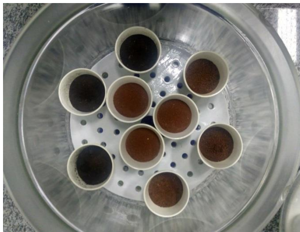
1- Amostras retiradas da mufla a 100 °C
