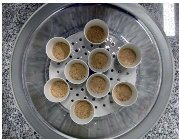
10- Amostras retiradas da mufla a 650 °C
