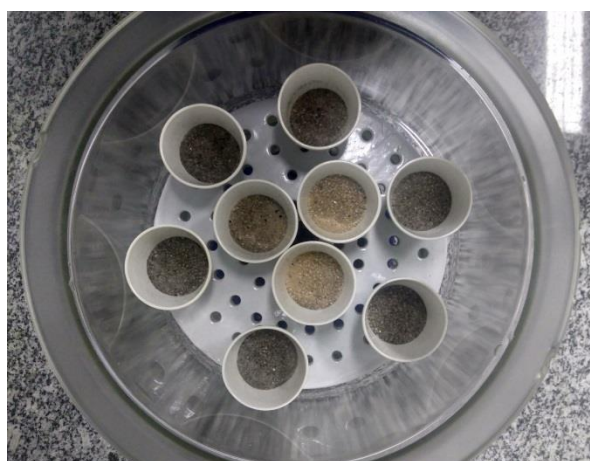
6- Amostras retiradas da mufla a 400 °C
