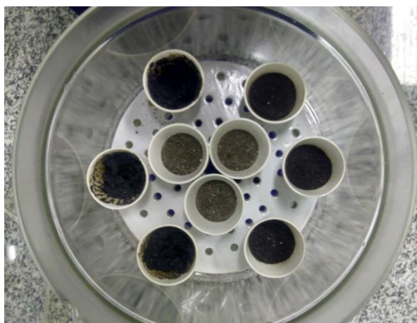
3- Amostras retiradas da mufla a 250 °C
