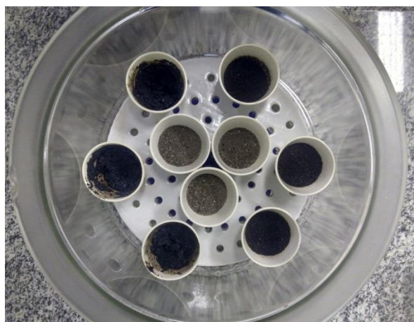
4- Amostras retiradas da mufla a 300 °C
