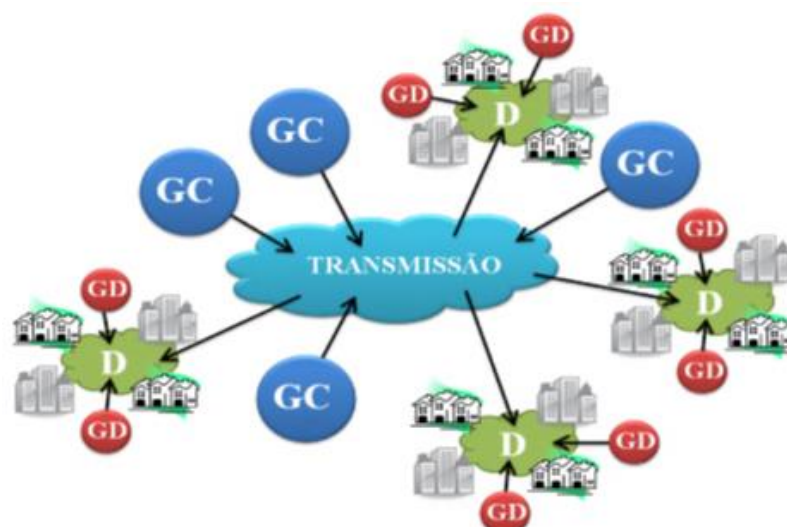
Figura 07: Esquema Simplificado de um Sistema Elétrico Interligado com Geração Distribuída. Fonte: ABREU, Y. V.; OLIVEIRA, M. A. G.; GUERRA, S. M. G., 2010. p. 82.
