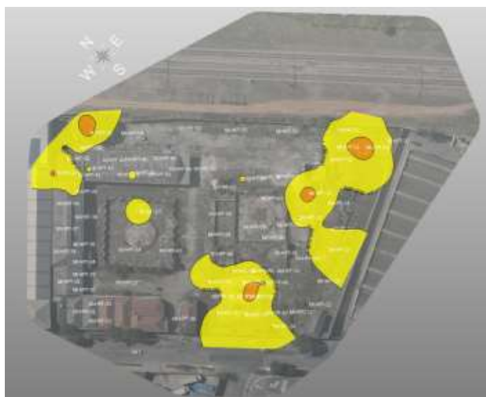
Figura 3 – Plumas com áreas fontes indicadas pelas sondagens de alta resolução.
