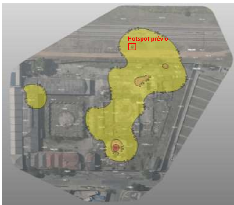
Figura 6 – Pluma dissolvida de benzeno acima dos valores orientadores.
