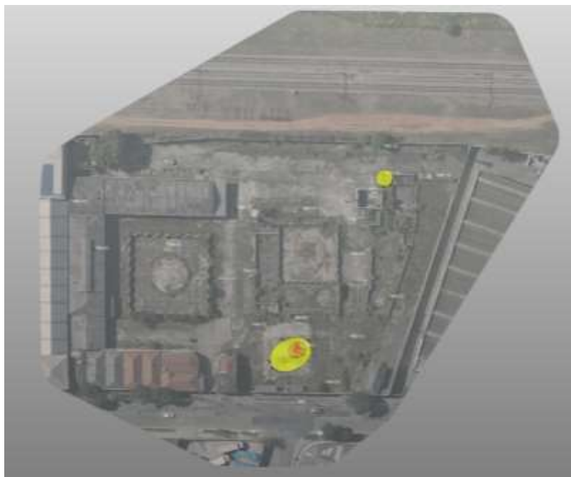
Figura 7 – Pluma de Benzeno em fase vapor acima dos valores orientadores.
