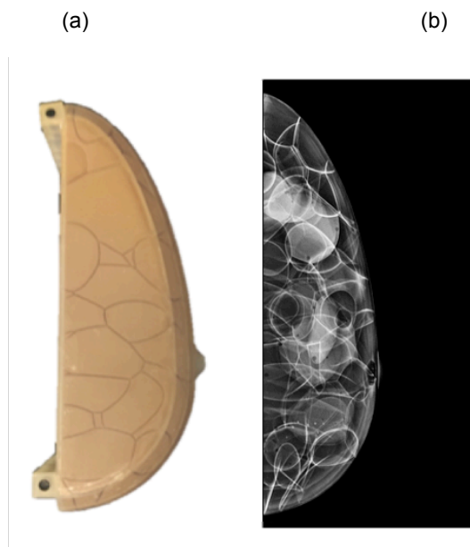
Figura 13: (a) Exemplo de um phantom antropomórfico desenvolvido na University of Pennsylvania ; (b) Imagem do phantom do item (a) tirada de um mamógrafo digital
