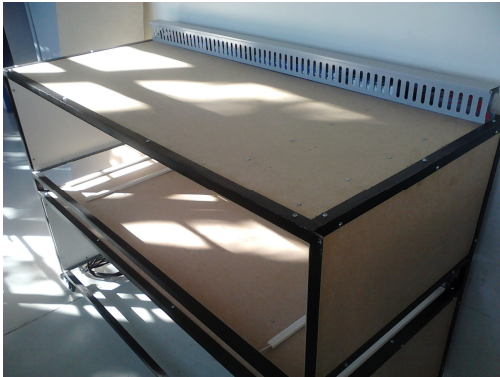
Figura 5.3 - Caixa para teste em painéis fotovoltaicos
