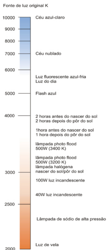
Figura 4.5 – Escala Kelvin de temperatura de luz. (fonte: ZIMER, 2011)
