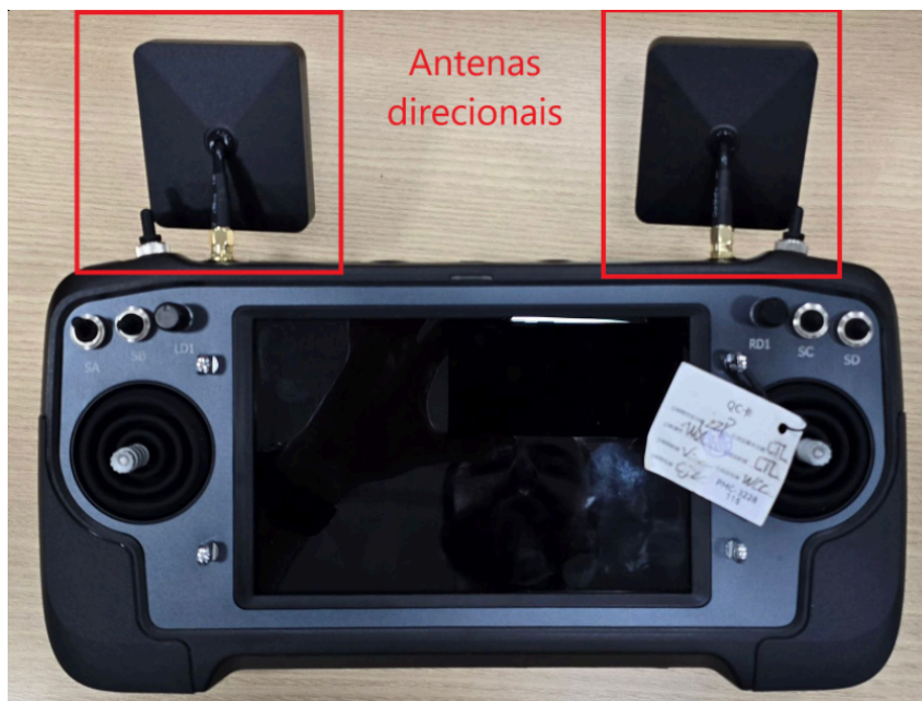
Figura 13: Controle remoto - SIYI MK32 com antena direcional de longo alcance
