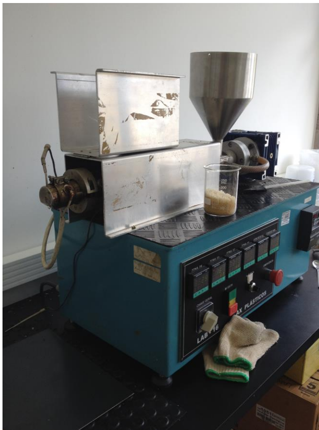
Figura 6: Extrusora utilizada na preparação das blendas ternárias.
