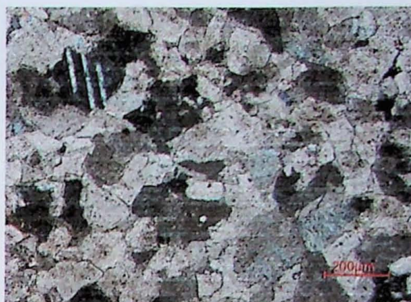
Foto 23 – Contatos suturados evidenciam deformação.
